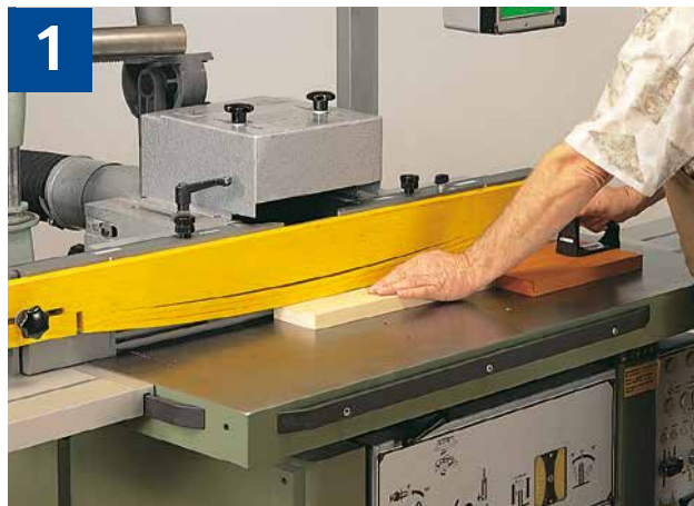
Handvorschub = Halten und Führen der Werkstücke von Hand
