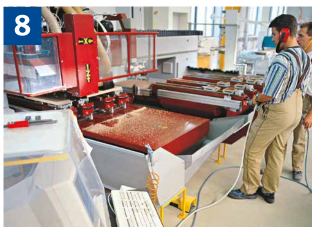
Mechanischer Vorschub = z. B. Arbeiten mit CNC-Bearbeitungszentrum
