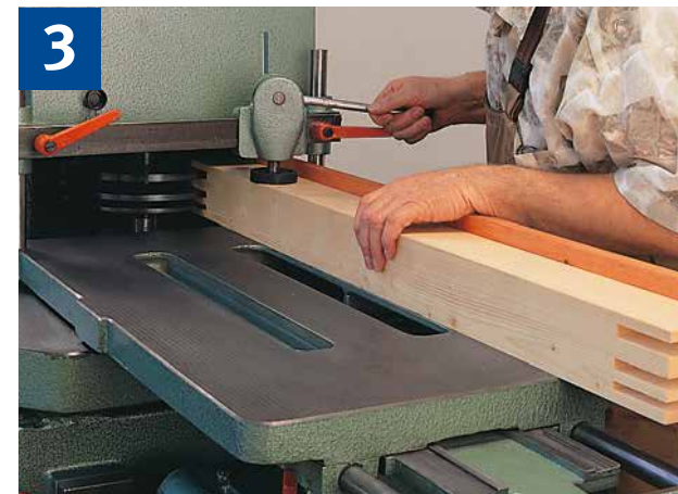
Handvorschub = Arbeiten mit dem Schiebeschlitten
