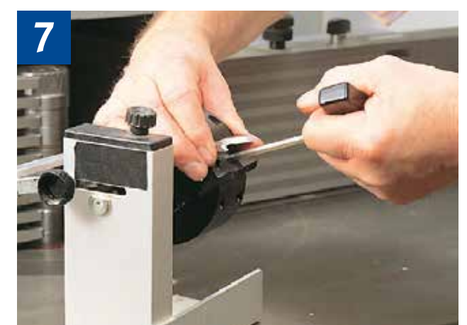
Lösen der Spanschrauben mit vorgegebenem Werkzeug (Imbusschlüssel)
