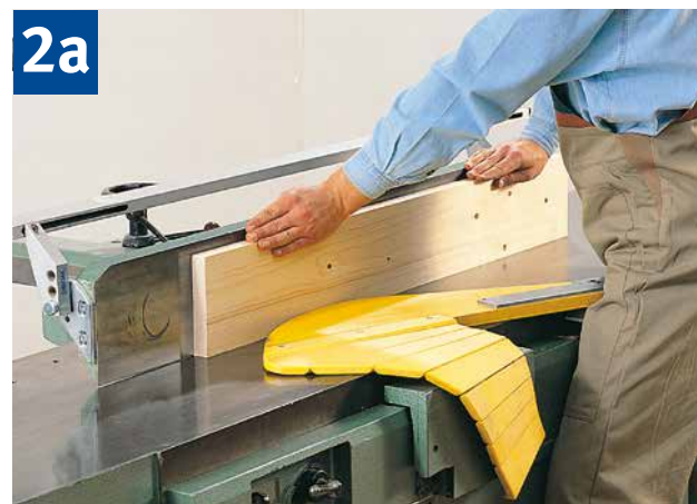
2a Fügen breiter Werkstücke mit Gliederschwingschutz
