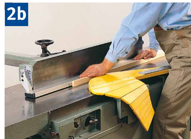
2b Abrichten und Fügen schmaler Werkstücke mit Gliederschwingschutz und Hilfsanschlag
