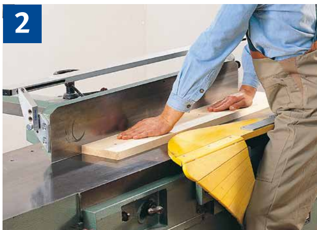
2 Abrichten breiter Werkstücke mit Gliederschwingschutz
