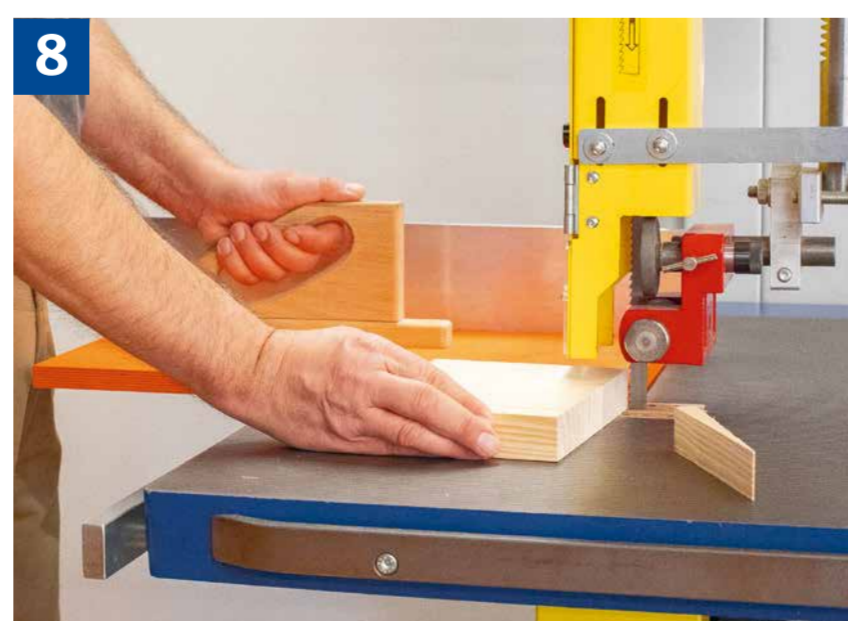
Sägen von Keilen mit Keilschneidlade
