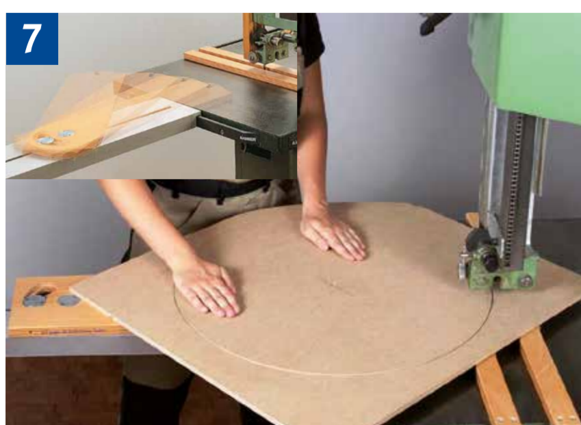
Vorrichtung und Handhaltung beim Herstellen kreisförmiger Werkstücke
