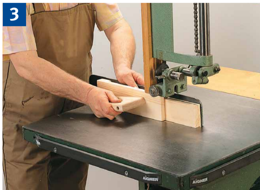
Auftrennen am Anschlag mit Zuführlade
