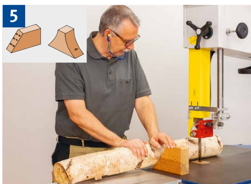
Quersägen von Rundholz mit Keilstütze
