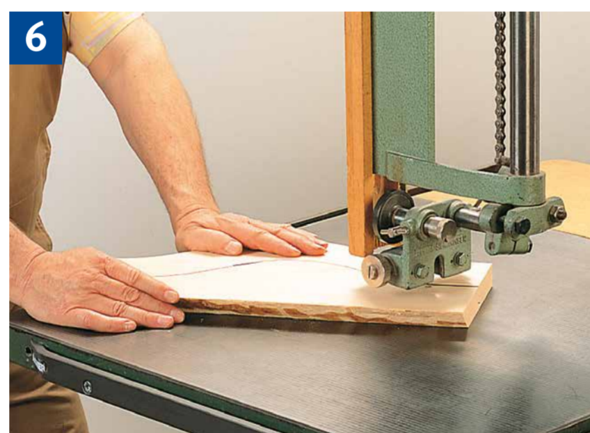
Handhaltung beim Herstellen geschweiften Werkstücke
