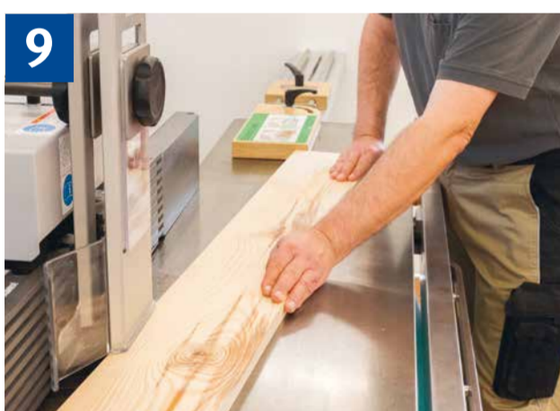
9 Einsetzfräsen großer Werkstücke mit Rückschlagsicherung
