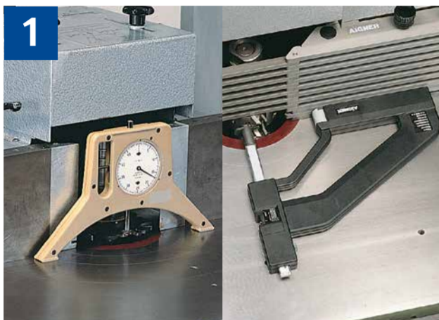
1 Einstellen von Fräshöhe und Frästiefe mit Messuhr
