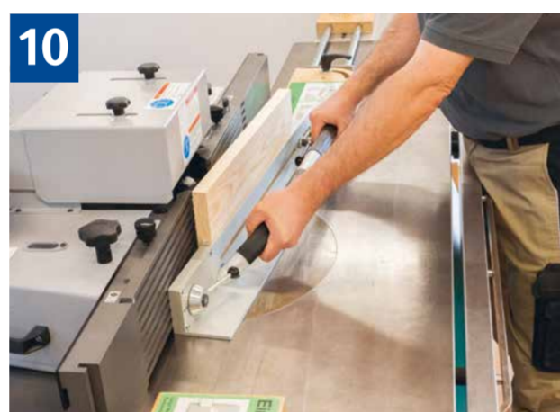
10 Einsetzfräsen kleiner Werkstücke mit Spannlatte und Rückschlagsicherung
