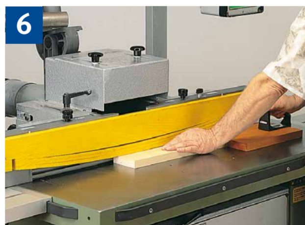
6 Fräsen von kleinen Werkstücken am Anschlag mit Bogenfeder und Schiebeh Holz
