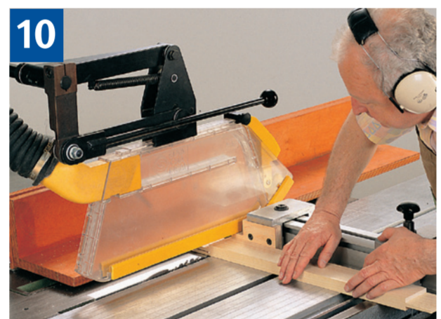
10 Schutzhaube und Handhaltung beim Absetzen von Zapfen
