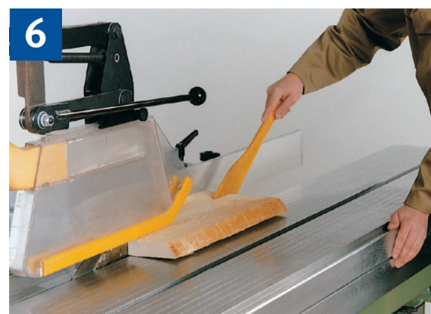
6 Sägen schmaler Werkstücke mit Schiebstock
