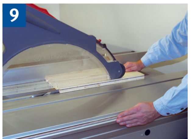
9 Schutzhaube und Handhaltung beim Fälzen
