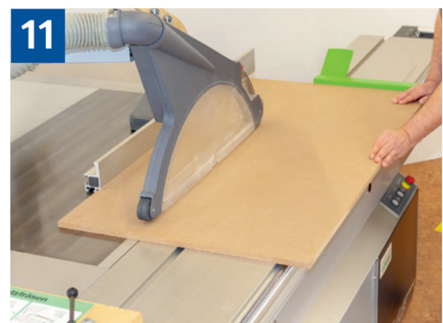
11 Schutzhaube und Handhaltung beim Einsetzsägen. Sägeblatt wird von unten nach oben durch das Werkstück angehoben.
