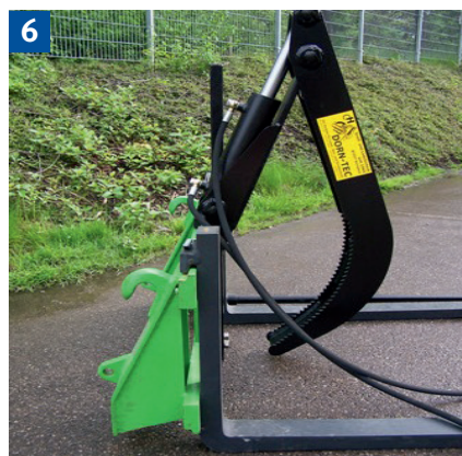
Gabelstapler mit Zangengreifer zum Transport von Rundholz
