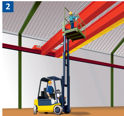
Instandhaltungsarbeiten mit Gabelstapler und Arbeitsbühne
