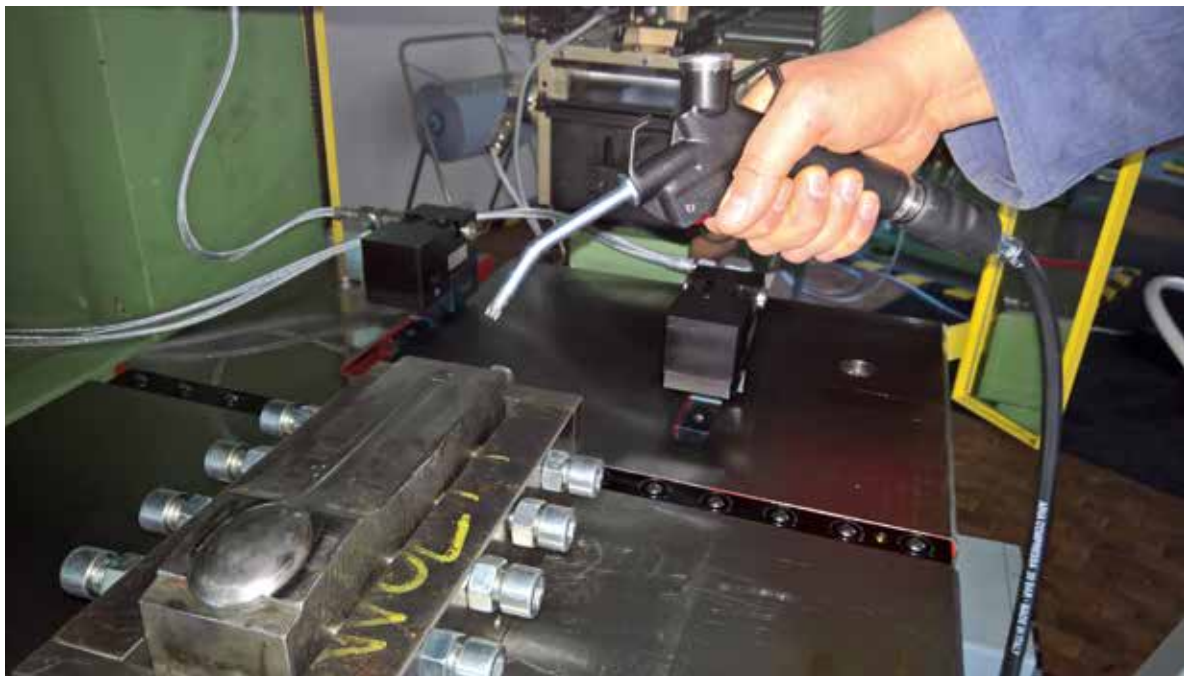
Lärmarme Sicherheitspistole mit Lavaldüse aus Edelstahl und Griff zur stufenlosen Steuerung der Blaskraft
