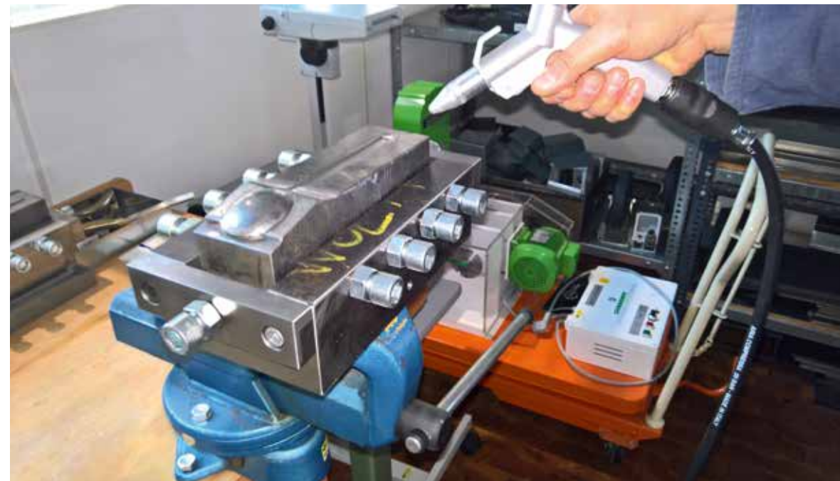
Lärmarme Sicherheitspistole mit aerodynamischer Aluminiumdüse und fünffacher Blaskraft gegenüber einer konventionellen Blaspistole
