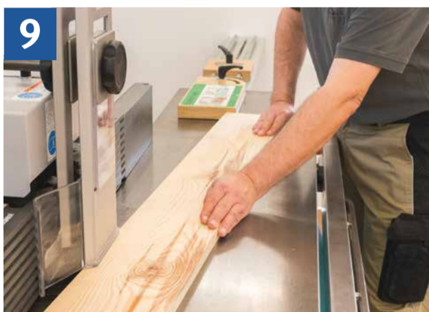
9 Einsetzfräsen großer Werkstücke mit Rückschlagsicherung
