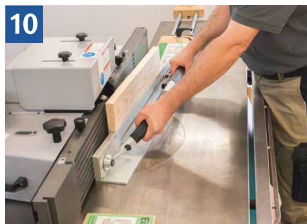
10 Einsetzfräsen kleiner Werkstücke mit Spannrolle und Rückschlagsicherung
