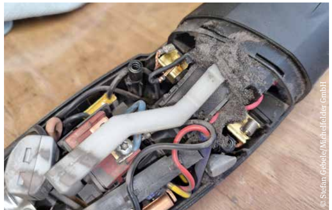
Abbildung 2: Agglomerierte Schleifpartikel im Inneren des Gerätes
