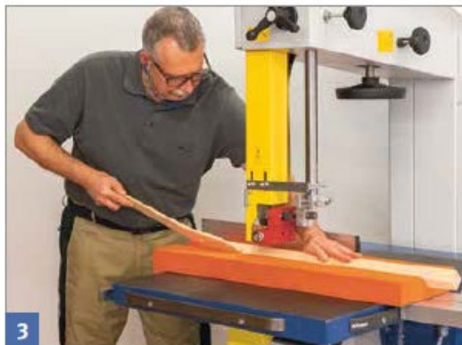
Wenn der Abstand zum Sägeblatt kleiner ist als 120 mm, Werkstück nicht mehr mit der Hand, sondern mit Schiebestock oder anderer Zuführhilfe vorschieben.
