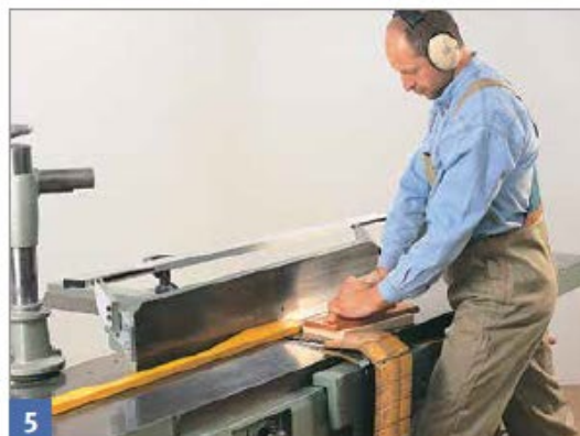
Messerwelle nur so weit unverdeckt lassen, wie es die Werkstückbreite erfordert.
