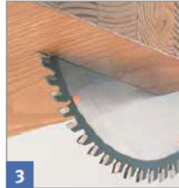
3 HW-Wechselzahn Für Platten mit beschichteten oder furnierten Oberflächen und Vollholz (Massivholz) quer zur Faserrichtung
