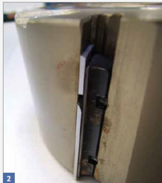
Durch Überlastung des Werkzeugs gebrochene Hartmetallschneide
