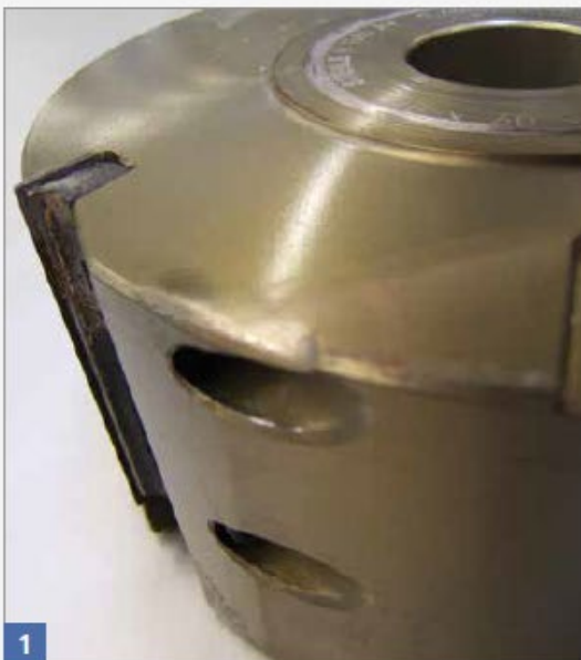
Durch Werkzeugsturz deformierter Aluminiumtragkörper
