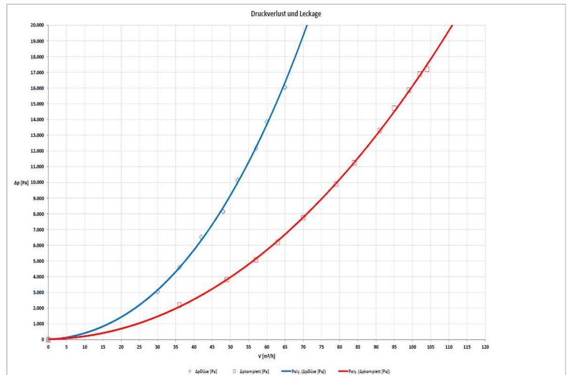
Kennlinien eines Absaugbrenners
