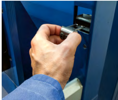
Manipulation: Ersatzbetätiger überbrücken und setzen die Schutztür außer Kraft.
