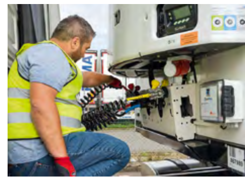
Die Bremsleitung (gelber Kupplungskopf) wird stets zuerst angeschlossen.
