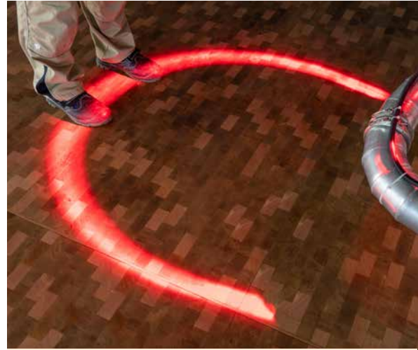
Wirkungsvolle Arbeitsschutz-Idee: LEDs projizieren Risikobereiche der Maschinen auf den Boden.
