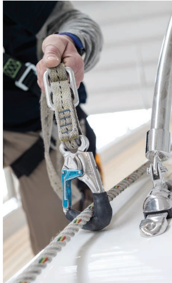
Beim Arbeiten auf den Decks der Yachten tragen die Beschäftigten immer Sicherheitsgeschirre.
