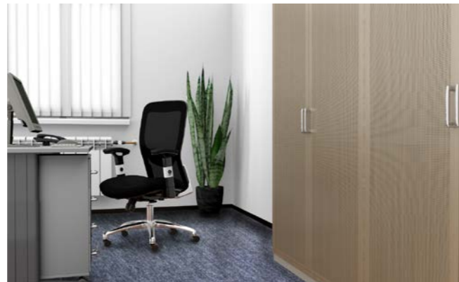
Abb. 5 Möglichkeiten zur Verbesserung der Raumakustik: Schallabsorbierende Lamellenstores und Möbel mit Schallabsorptionsfläche sowie schallabsorbierender Teppichboden
