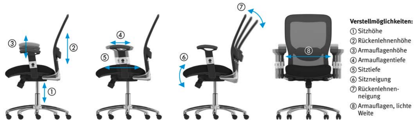
Abb. 12 Verstellmöglichkeiten an einem Büroarbeitsstuhl
