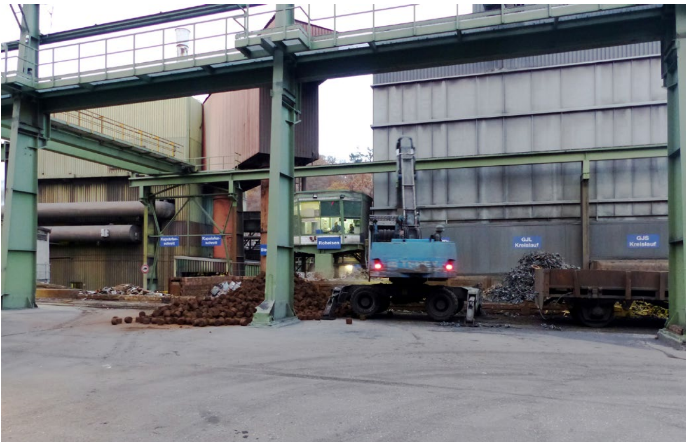
Abb. 15 Gattierung für Kupolofenschmelzbetrieb
