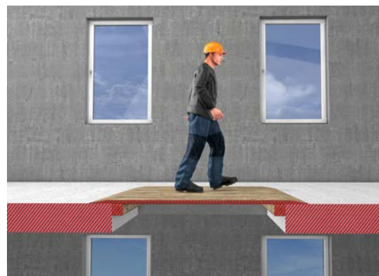
Abb. 83 Darstellung einer Bodenabdeckung im Schnitt
