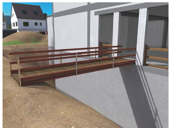
Abb. 81 Laufsteg mit Seitenschutz als Verkehrsweg
