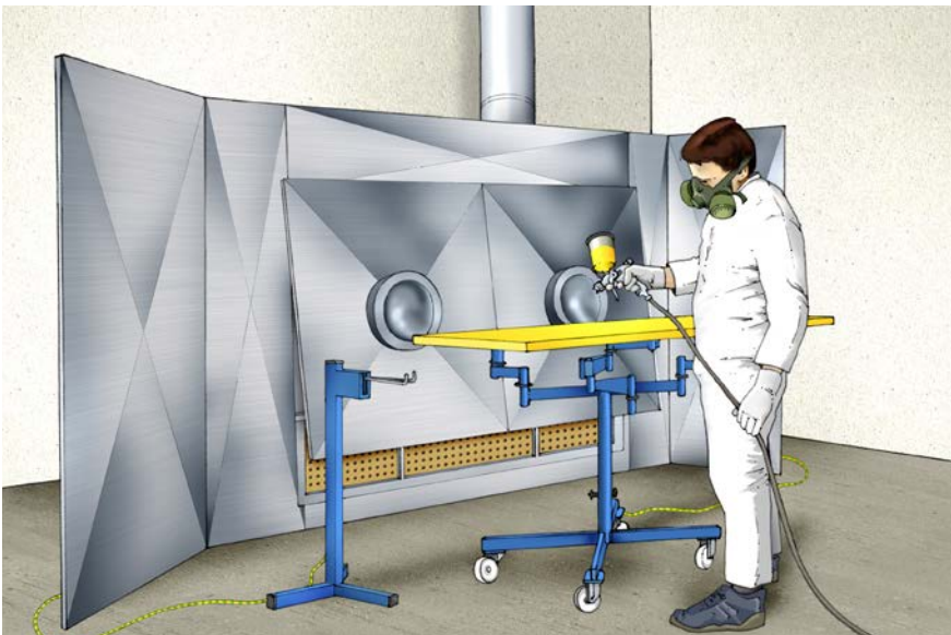
Abb. 71 Spritzstand mit Prallblech
