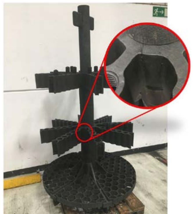
Abb. 38 Rissbildung an Chargengestell
