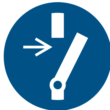
Bild 18 Gebotszeichen „Vor Wartung oder Reparatur freischalten“
