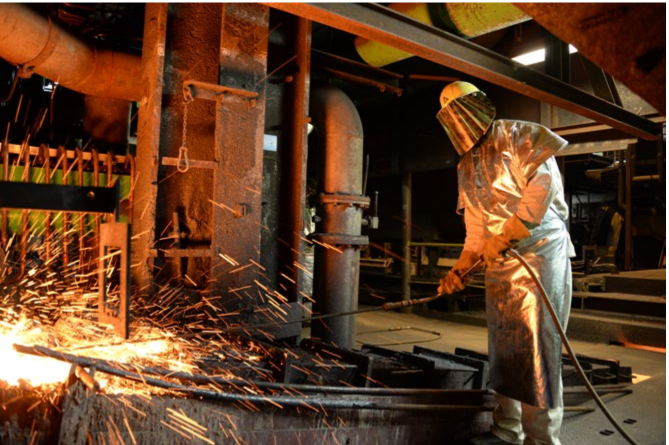
Bild 11 Arbeiten mit der Sauerstofflanze
