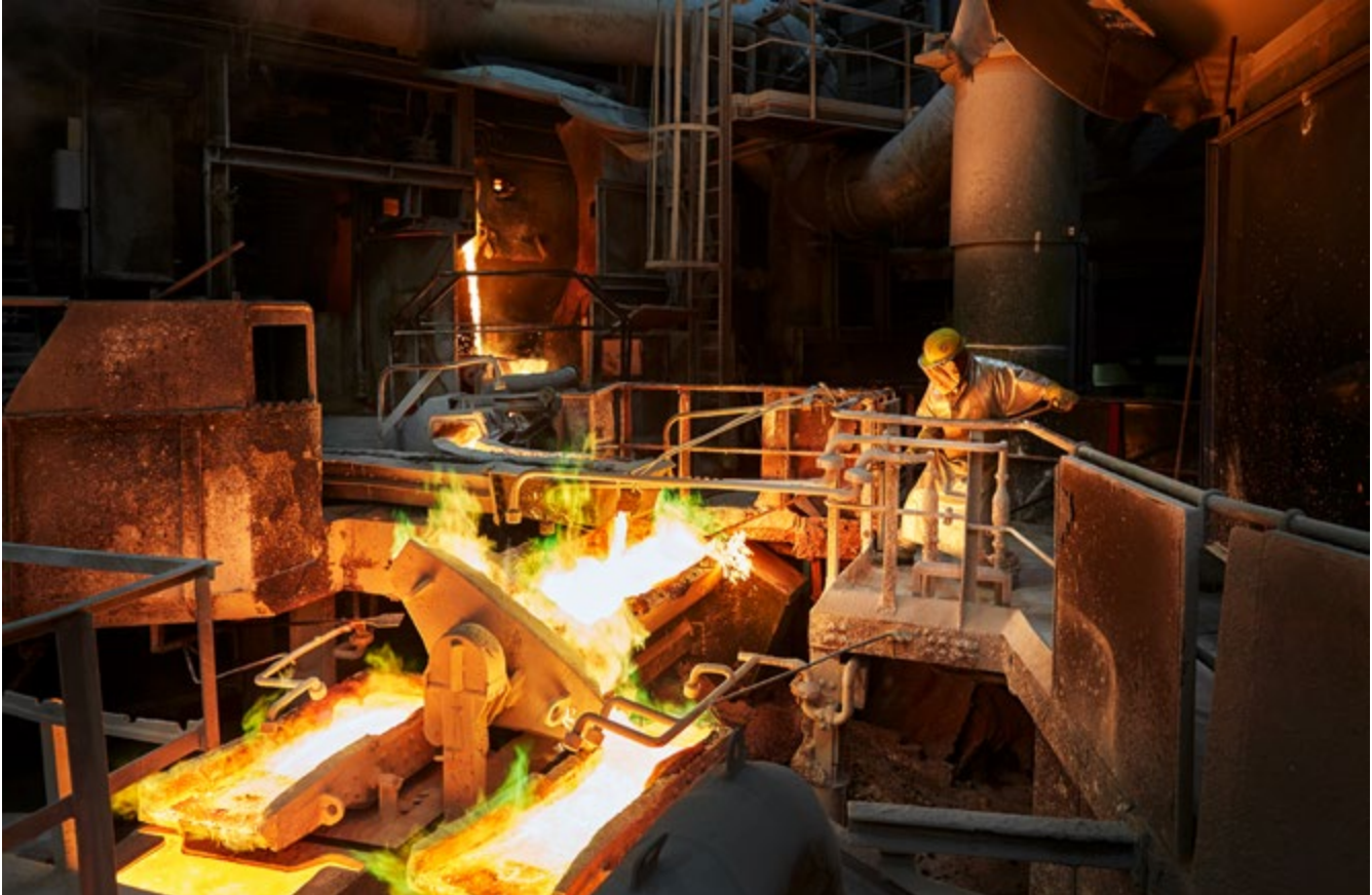
Abb. 1 Arbeiten im Abstichbereich
