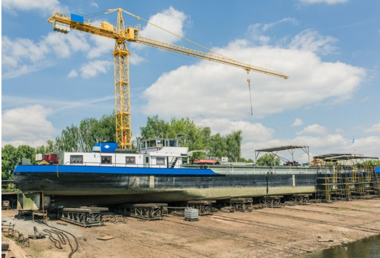
Abb. 63 Querslipanlage mit Binnenschiff
