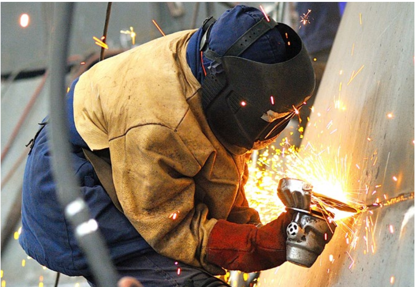
Abb. 23 Ausschleifen einer Außenhautschweißnaht
