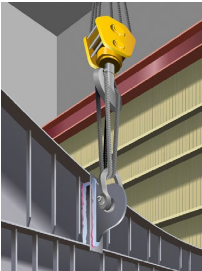
Abb. 65 Geprüfte Schweißanschlüsse an einem Transport- und Anschlagpunkt
