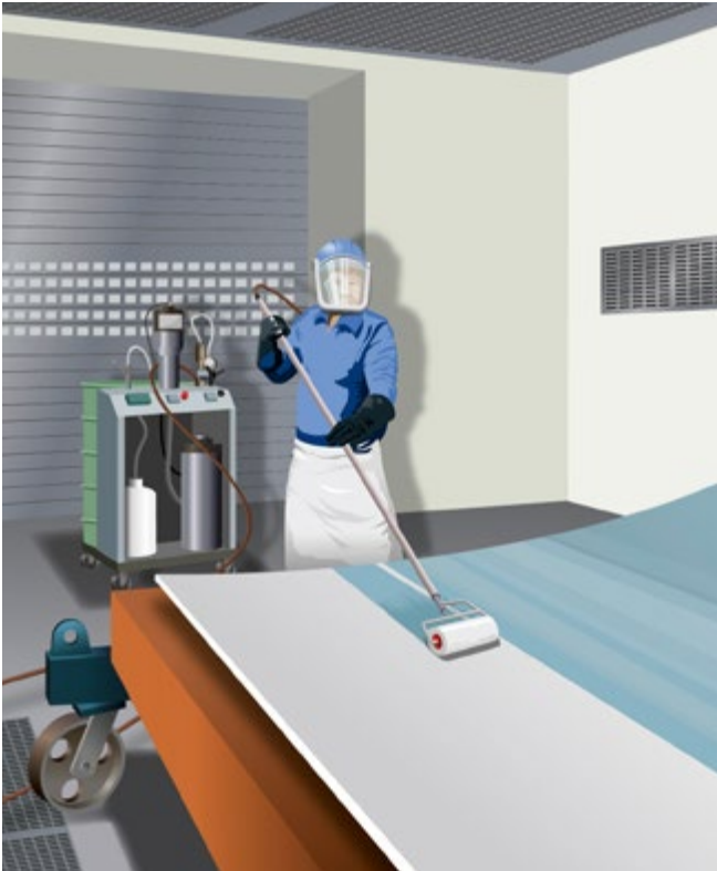
Abb. 75 GFK-Fertigung in der Werkstatt
