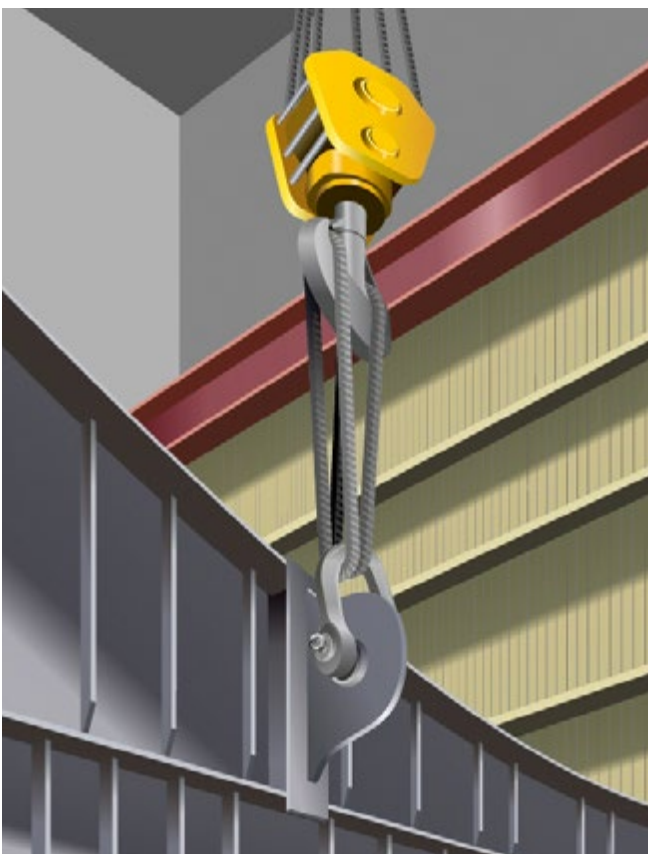
Abb. 7 Geschweißtes Transport- und Wendeauge
