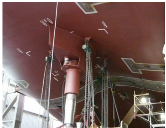
Abb. 9 Hilfsaugen zur Rudermontage
