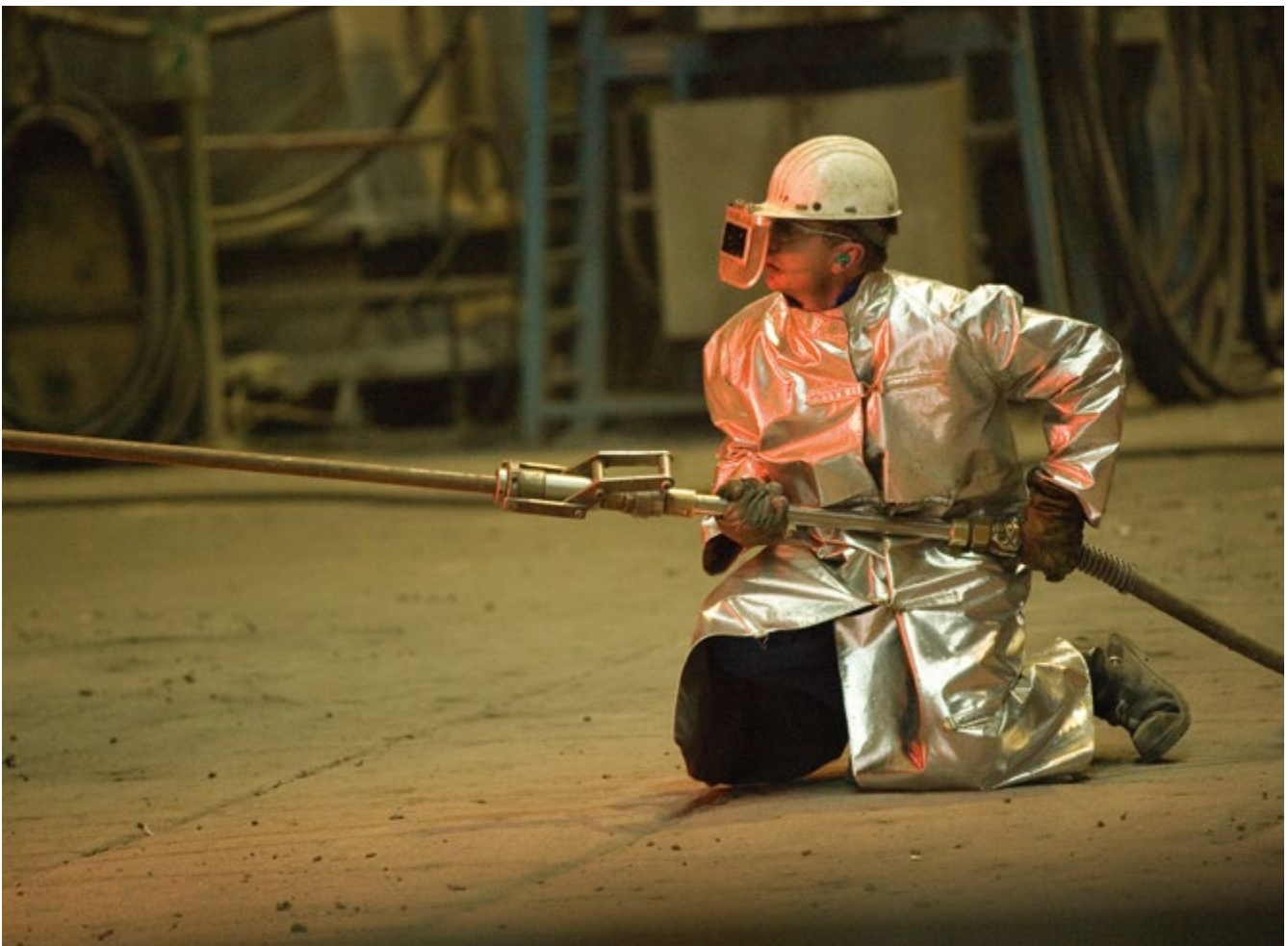
Bild 11 Arbeiten mit der Sauerstofflanze
