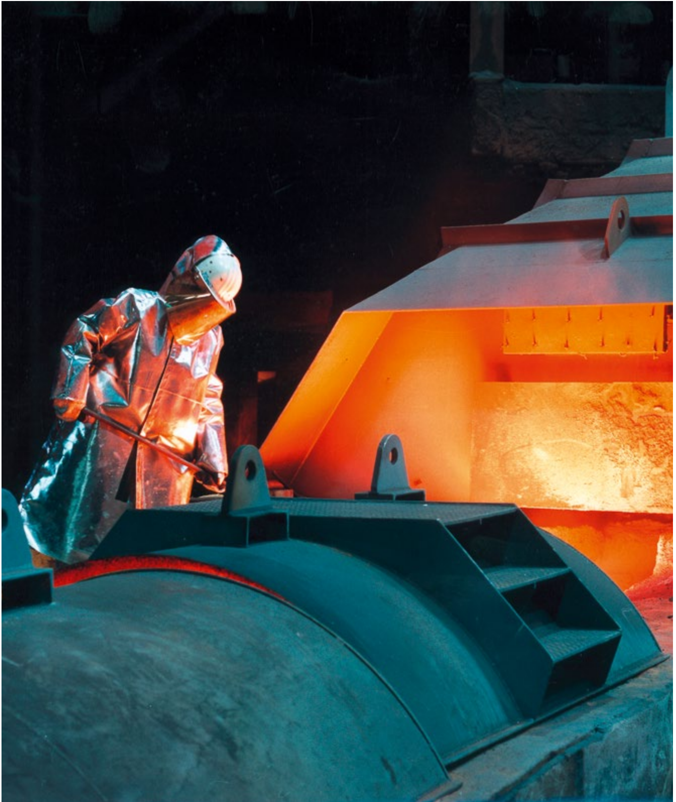
Bild 1 Probenahme am Hochofen
