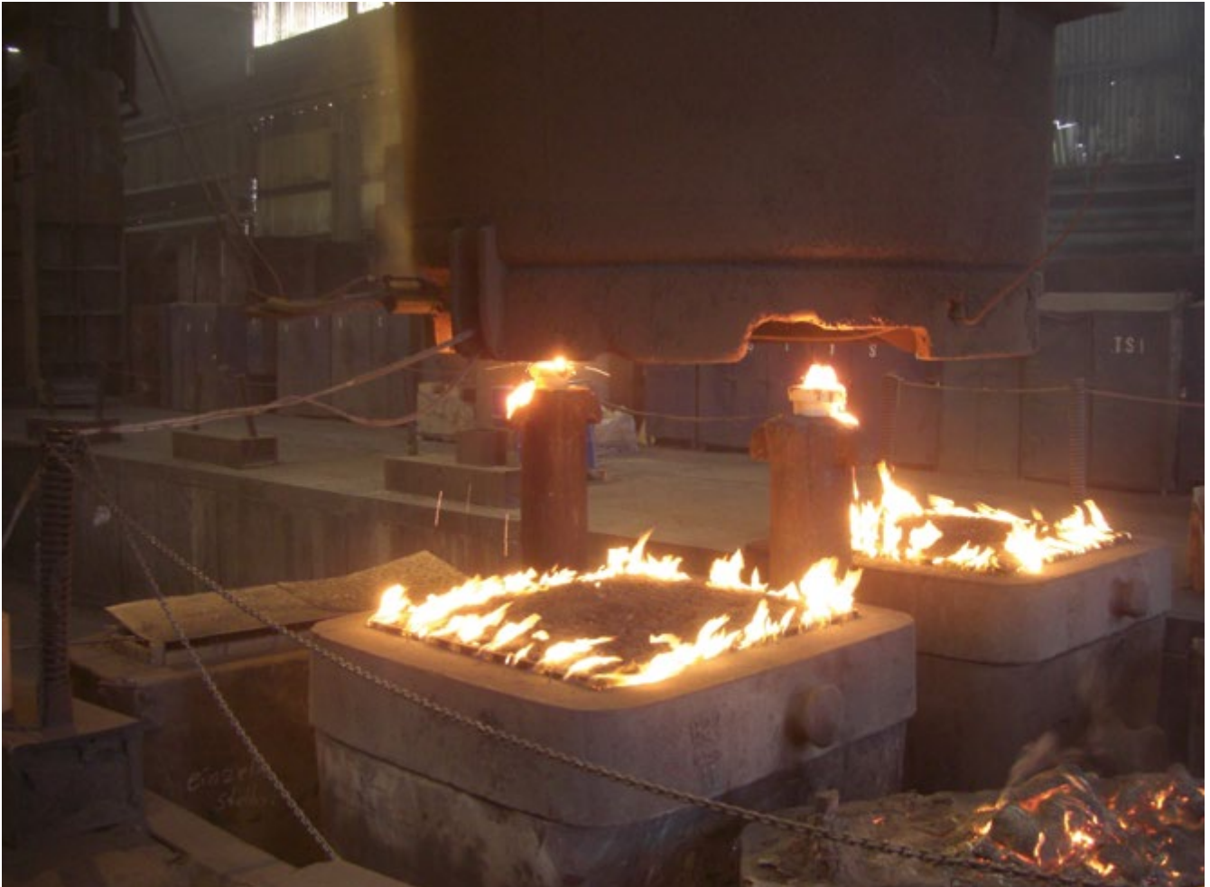
Bild 20 Abguss im Standgussverfahren
