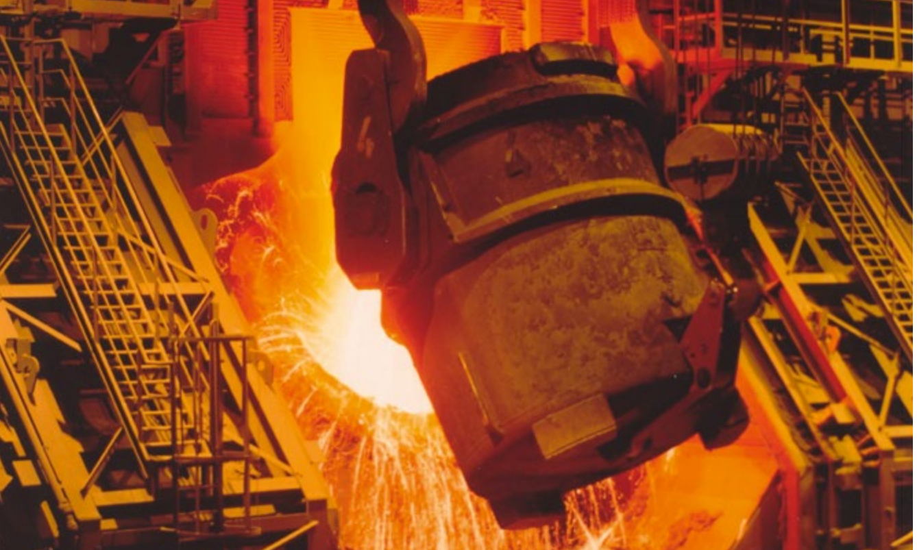
Bild 17 Befüllen eines LD-Konverters
