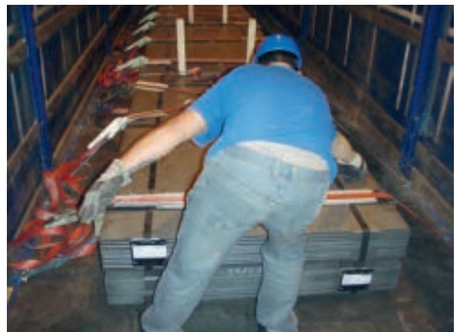
Abb. 10-27 Fixieren mit Zurrgurten
