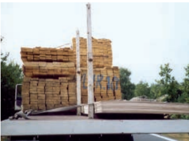
Abb. 10-40 Mittelrunge als Kippsicherung
