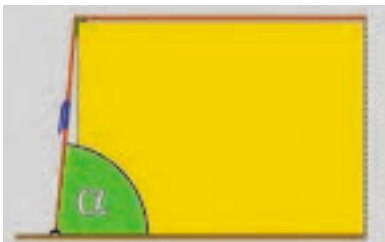
Abb. 7-17 \alpha etwa 90^\circ = die Vorspannkraft wirkt zu 100 %
