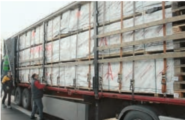
Abb. 7-16 Die Ladung wurde lückenlos geladen und hält dem Druck der Zurrmittel stand.
