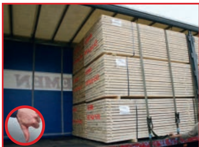
Abb. 10-43 Kein Formschluss in Fahrtrichtung
