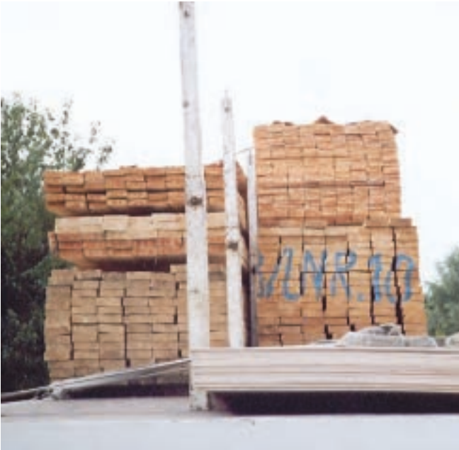
Abb. 8-42 Nicht standfeste Ladungen können formschlüssig oder kraftschlüssig gegen Kippen gesichert werden.
