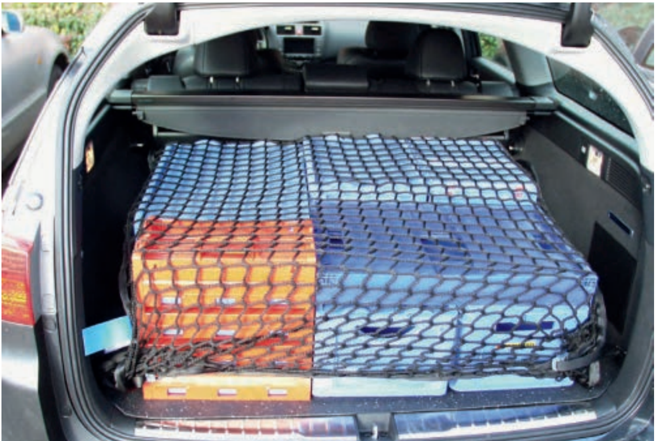
Abb. 10-1 Ladungssicherung im Pkw mit Hilfe eines Sicherungsnetzes
