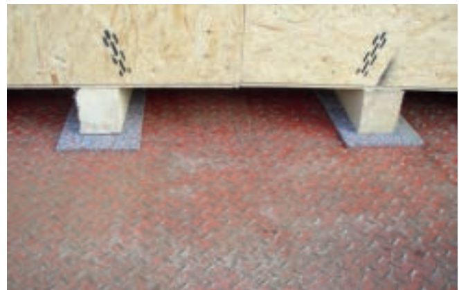
Abb. 6-75 RHM muss verhindern, dass sich die Ladung und die Ladefläche berühren.
