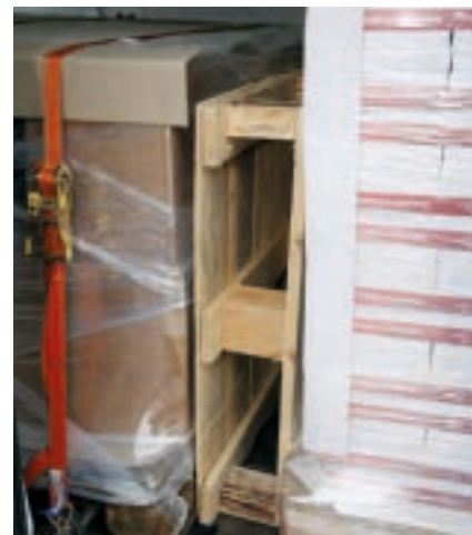
Abb. 7-13 Eine Leerpalette sichert die Ladelücke.
