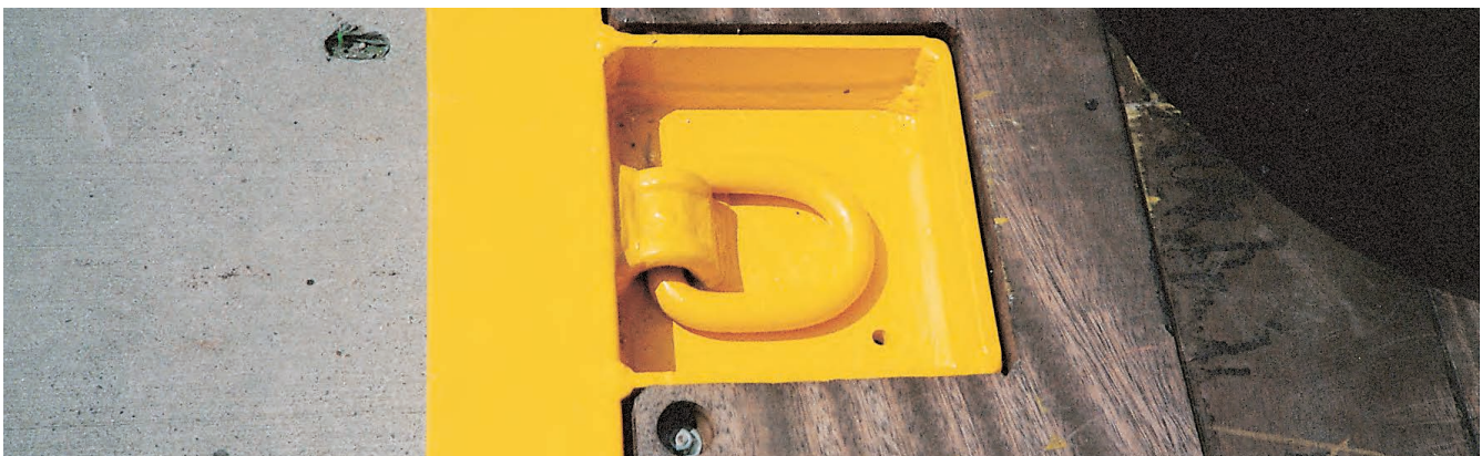
Abb. 5-25 Zurpunkte gemäß DIN EN 12640: Sicherungsvorrichtung am Fahrzeug, an denen ein Zurrmittel direkt befestigt werden kann
