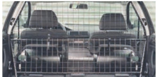
Abb. 6-46 Nachträglich eingebautes Trenngitter nach DIN 75410-2
