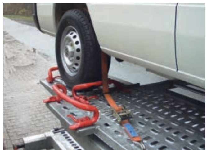
Abb. 10-105 Drei-Punkt-Zurrgurt in Kombination mit Radvorlegern
