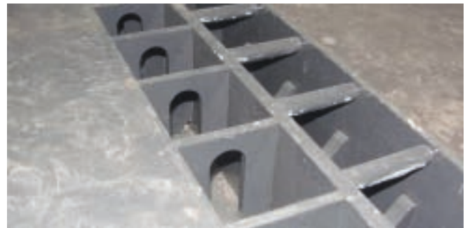
Abb. 5-29 Rungentaschenreihe mit Zurrloch; Belastung Zurr-löcher 2.000 daN
