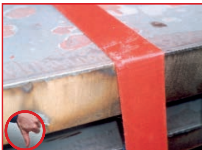
Abb. 10-73 Ohne Kantenschutz: Gurte werden zerschnitten
