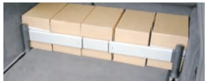
Abb. 6-47 Schienensystem im Gepäckraum für Teleskopstangen
