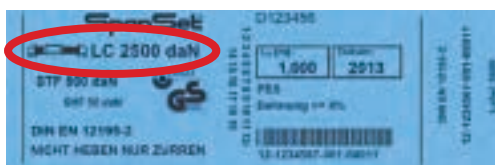
Abb. 8-38 Zurrgurtetikette eines Zurrmittels mit einer LC von 2.500 daN
