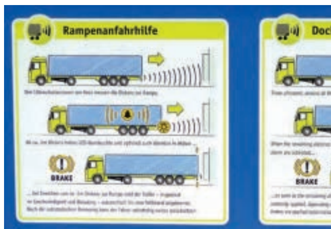
Abb. 2-7 Beispiel: Funktionsweise einer Rampenanfahrhilfe
