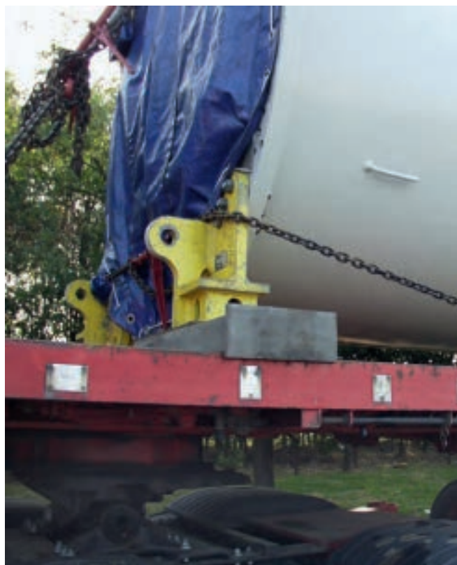
Abb. 7-35 / 7-36 Praxisbeispiele für das Kopfschlingenzurren
