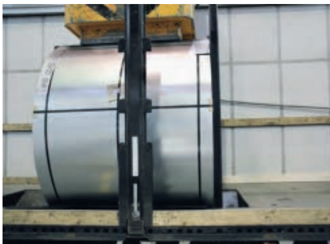
Abb. 10-65 Positionieren eines Coils gegen Steckungen
