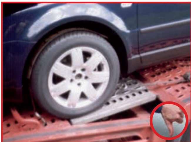
Abb. 10-106 Falsche Position: Radvorleger kann Rad nicht blockieren
