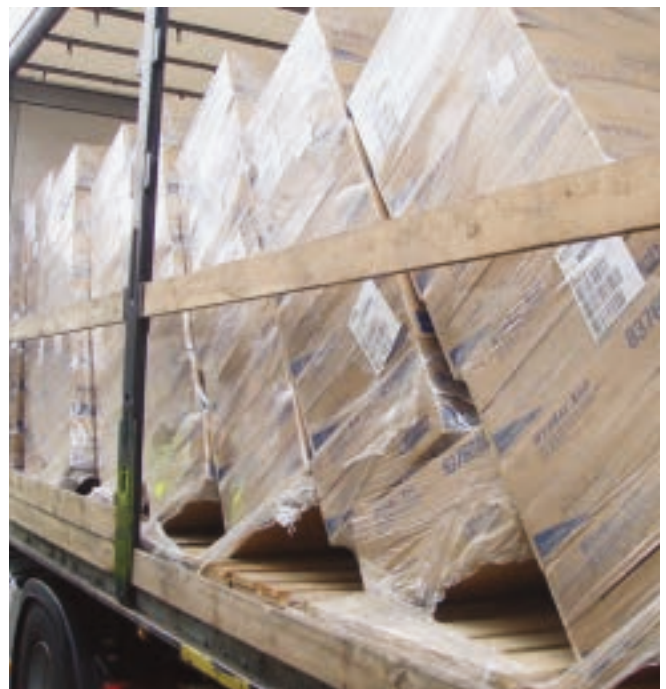
Abb. 8-41 80 % des Ladungsgewichts wirken bei einer Gefahrenbremsung nach vorne
