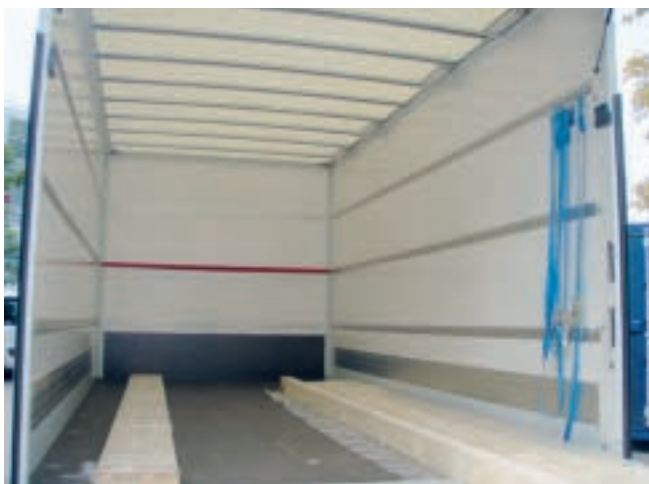
Abb. 10-49 Kofferaufbauten: ausreichend belastbar
