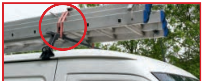
Abb. 5-6 Dachträger müssen fest mit dem Fahrzeug verbunden sein, so dass die im Fahrbetrieb auftretenden Massenkräfte aufgenommen werden können. Bei der Beladung des Dachträgers sind die Belastbarkeit des Trägers, die zGM, die Achslasten sowie die Belastbarkeit der Befestigungspunkte des Fahrzeugs zu beachten. Achtung: Auf den Gesamt-schwerpunkt achten. Anm.: Leitern sollten auf einem Dachträger direkt an der Strebe festgezurr werden. Das auf dem Foto gezeigte Niederrücken ist keine geeignete Art der Ladungssicherung!
