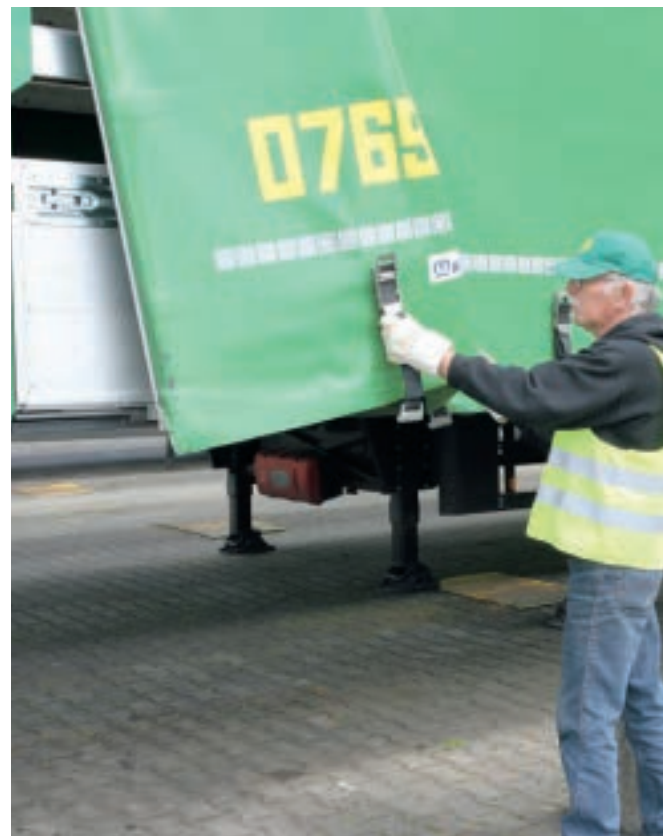
Abb. 2-26 Bei Curtainsidern lässt sich die Plane vom Boden aus öffnen. Dadurch können Kletterunfälle vermieden werden.
