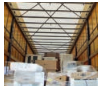
Abb. 5-15 Code XL-Fahrzeugaufbau (Dachverstrebungen zur Aussteifung)
