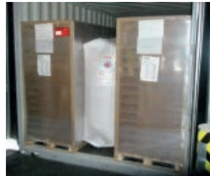
Abb. 7-12 Ladelücken sollten immer gesichert sein. Sie können durch füllende Hilfsmittel (hier z. B. Airbags) gesichert werden.
