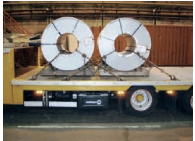
Abb. 10-62 Coils auf Palette – durch Schlingenzurren gesichert
