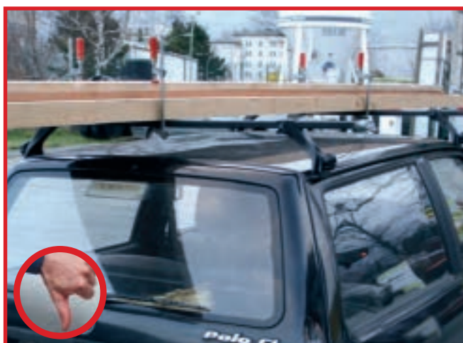
Abb. 10-5 Schraubzwingen sind keine Ladungssicherungshilfsmittel
