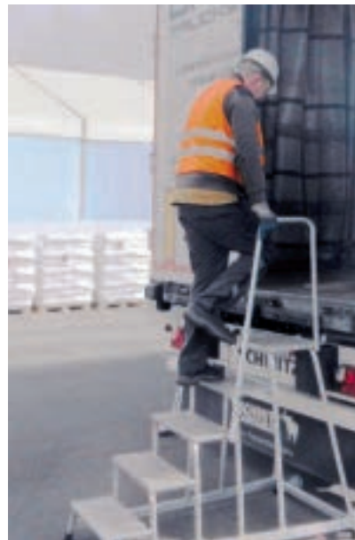
Abb. 2-23 / 2-24 Geländer, Haltegriffe, Laufstege, Stand- und Arbeitsflächen sowie abnehmbare Absturzsicherungen müssen genutzt werden.
