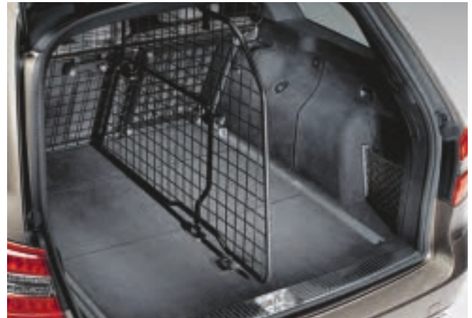
Abb. 6-45 Kombinierbare Stahlgitter (Raumteilung/Schutz des Fahrgastraums)
