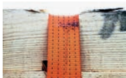
Abb. 7-20 / Abb 7-21 Die Ladung kann dem Druck nicht standhalten.
