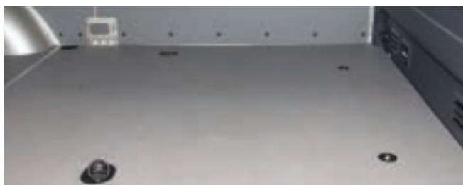
Abb. 5-7 Beispiele für Zurrpunkte in einem Kastenwagen
