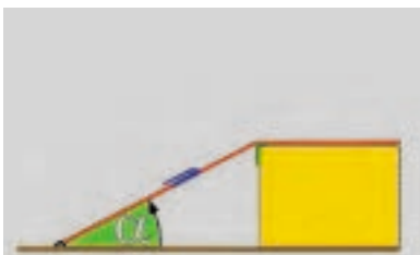
Abb. 7-19 \alpha etwa 30^\circ = die Vorspannkraft wirkt nur zu 50 %
