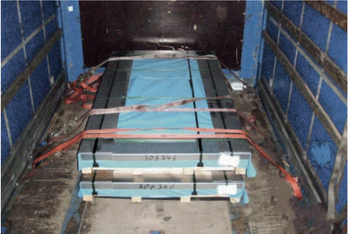
Abb. 10-96 Formschluss in Fahrtrichtung durch die Stirnwand
