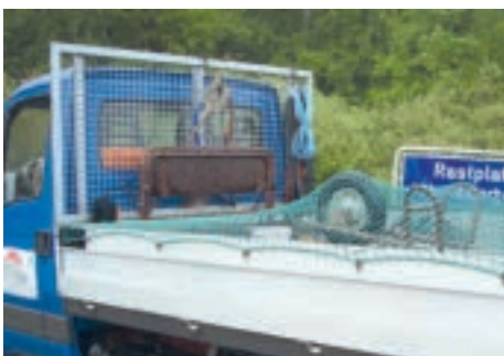
Abb. 6-38 Beispiel für die Sicherung von leichter Ladung auf einem Transporter mit offener Ladefläche
