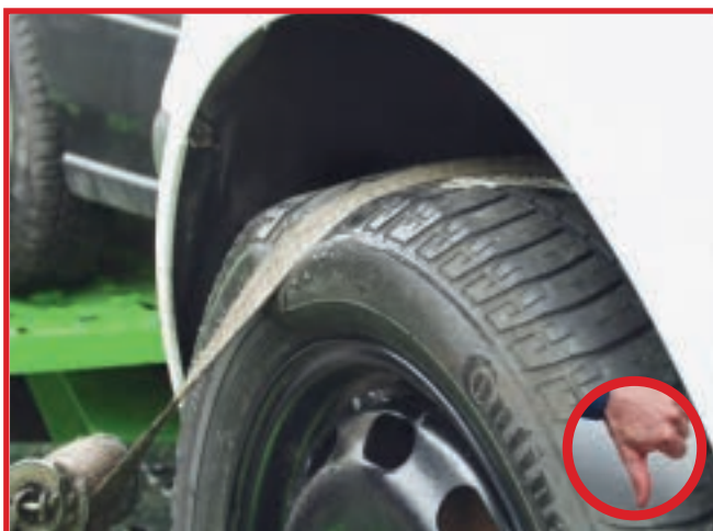
Abb. 10-107 Falsche Gurtführung: Reifen kann Schaden nehmen
