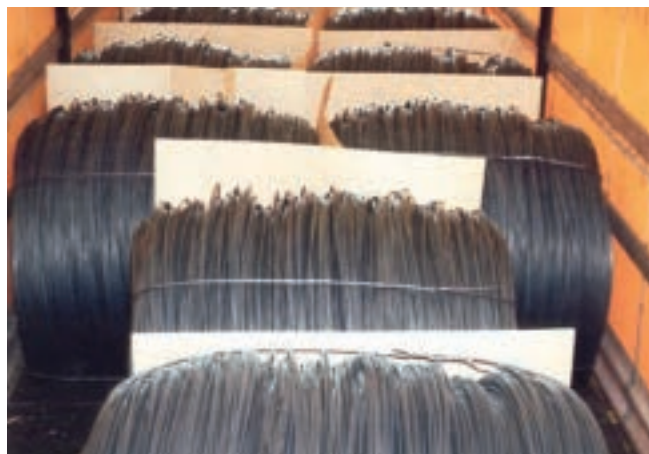
Abb. 10-86 Unpalettiert mit waagerechter Wickelachse; muss noch gegurtet werden!
