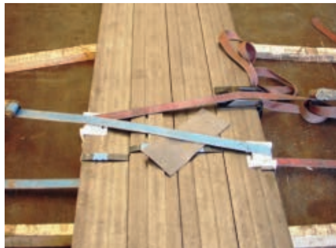
Abb. 10-95 Ersatz für Steckungen: Seitenschlingen
