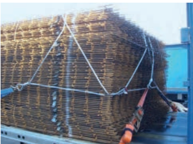
Abb. 10-75 Direktzurren mit speziellem Drahtseilsystem
