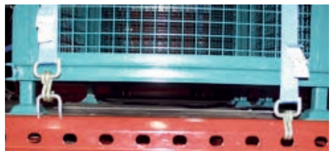
Abb. 5-30 Durch Mehrpunkt-Zurrsysteme können schwere Einzellasten dem Lastverteilungsplan entsprechend punktgenau platziert und gesichert werden.
