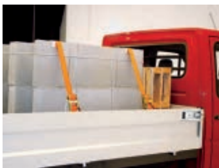
Abb. 7-41 Praxisbeispiel: Leerpaletten als Hilfsmittel zum Herstellen des Formschlusses in Fahrtrichtung in Kombination mit Niederzurren
