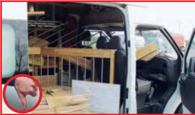
Abb. 10-8 Risikotransport für die Insassen; Transporter ohne Trennwand
