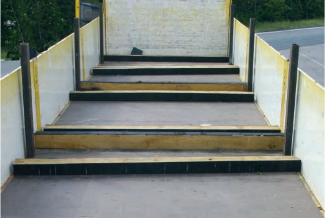
Abb. 10-25 Anti-Rutsch-Balken (müssen noch richtig positioniert werden!)
