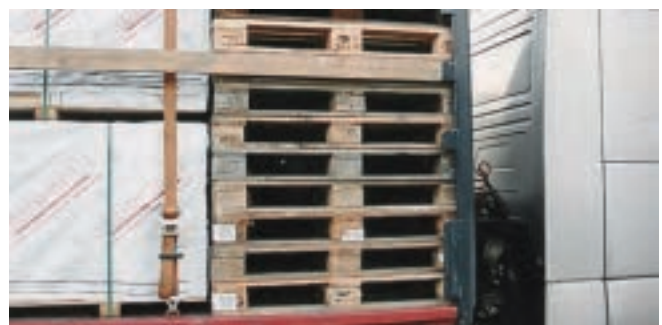
Abb. 6-67 / 6-68 Leerpaletten können stehend oder liegend eingesetzt werden.
