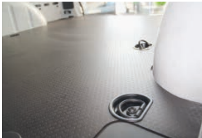
Abb. 5-8 Detailaufnahme eines im Boden eingelassenen Zurrpunkts
