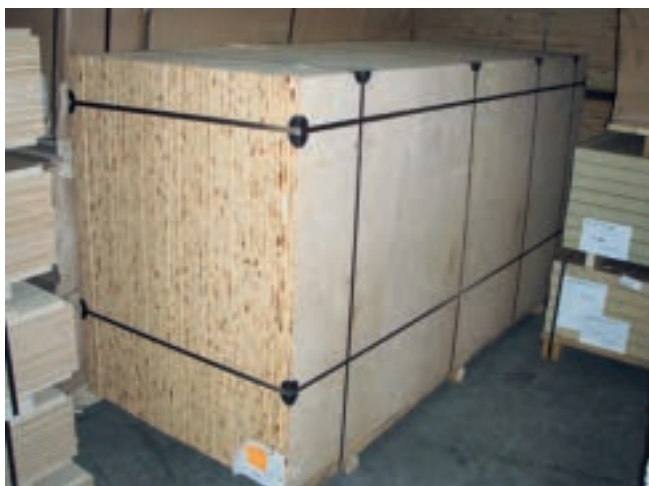
Abb. 10-35 Mit Umreifungsbändern paketierte Ladeeinheiten
