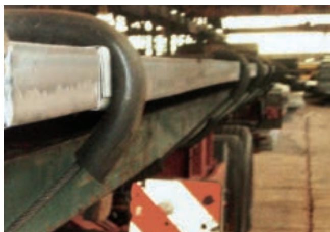
Abb. 10-72 Konsequenter Einsatz von Kantenschutzmitteln
