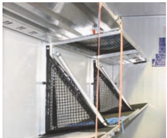
Abb. 6-51 Jedes einzelne der Klappregale wird durch ein Netz gesichert.
