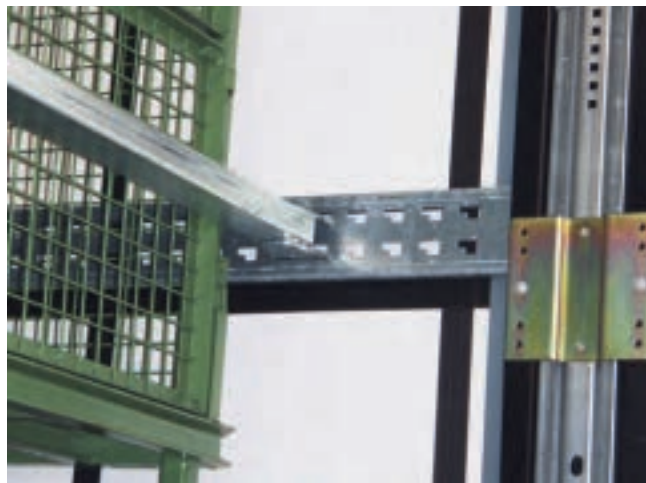
Abb. 10-59 Kann deutlich mehr Ladung sichern: Sperrbalken
