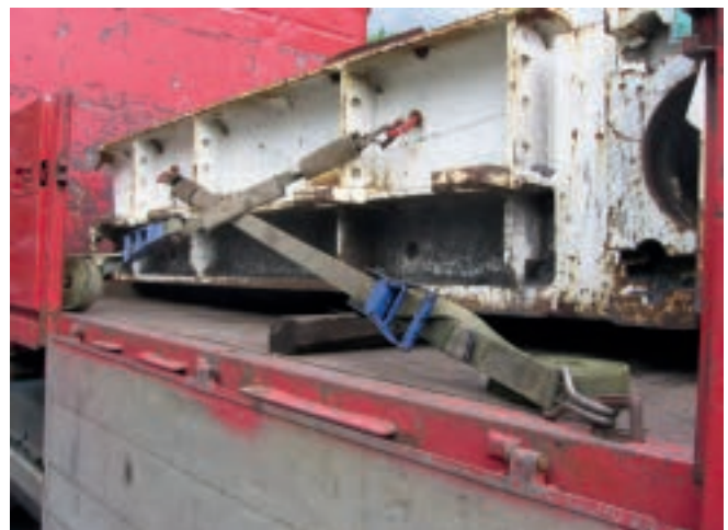
Abb. 7-29 bis 7-31 Praxisbeispiele: Diagonalzurren schwerer Bauteile oder Maschinen
