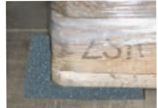
Abb. 3-10 Anti-Rutsch-Material zwischen Trailerboden und Palette.
