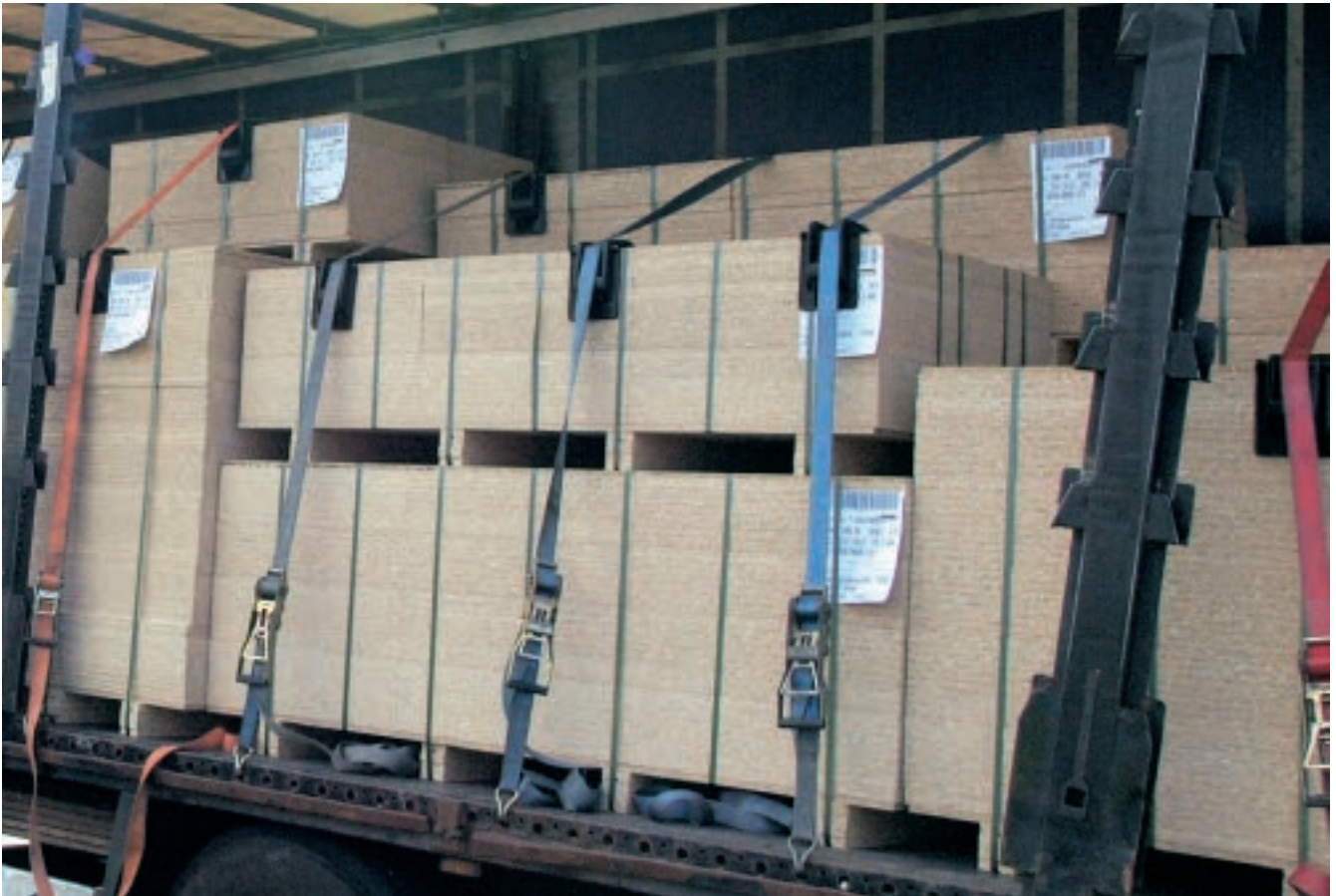
Abb. 10-32 Transportsichere Ladeeinheiten erleichtern die Ladungssicherung.
