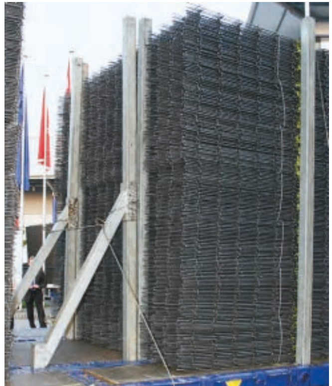
Abb. 6-58 Beispiel für den Einsatz von Steckungen zur Ladungssicherung
