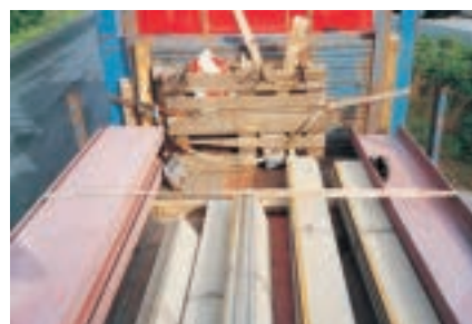
Abb. 7-23 Das Ladegut kann wegen der Ladelücken durch die Zurrmittel in Richtung der Mitte der Ladefläche gedrückt werden. Dadurch wird keine Vorspannkraft mehr wirksam.
