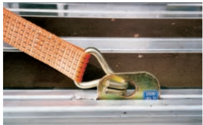
Abb. 5-29 Rungentaschenreihe mit Zurrloch; Belastung Zurr-löcher 2.000 daN
