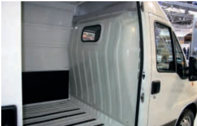
Abb. 10-10 Trennwand schützt die Insassen
