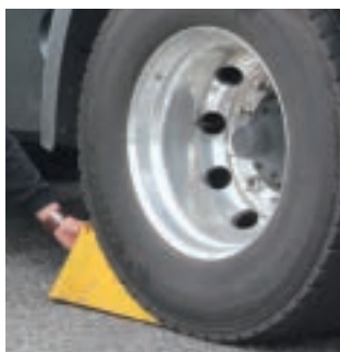
Abb. 1-14 Sicherung des Fahrzeugs mit Unterlegkeilen
