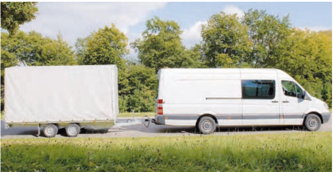
Abb. 5-13 Beispiel für einen Anhänger mit Pritschenaufbau und einer zGM bis einschließlich 3,5 t
