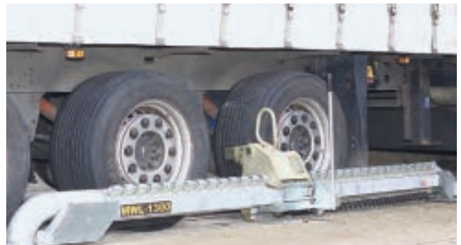
Abb. 2-15 Manuelle Verriegelung zur Sicherung des Lkw
