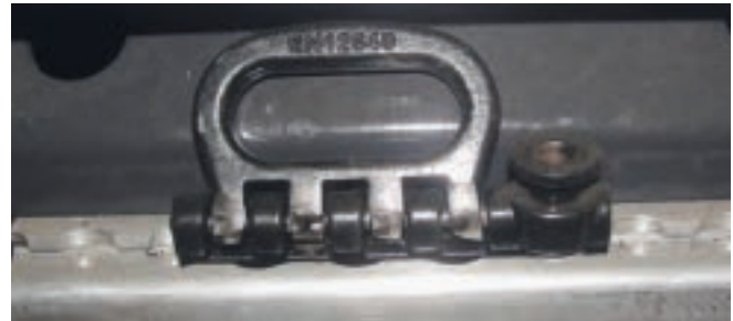
Abb. 5-28 Zurrschienen-system mit Rasterabstand
