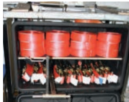
Abb. 9-2 Beispiel: In einem Staukasten sind die Zurrmittel übersichtlich und vor Spritzwasser geschützt untergebracht.
