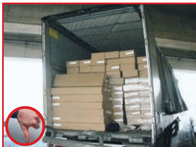
Abb. 10-51 Schnell überlastet: Planenaufbauten
