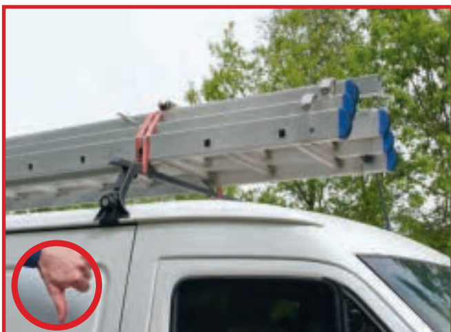
Abb. 10-22 Hier nicht geeignet zur Ladungssicherung: Niederzurren
