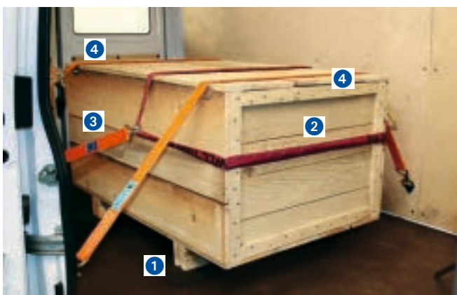
Abb. 7-42 Diese Ladung wurde durch Niederzurren (Kraftschluss) und zusätzlich nach vorn durch eine Kopfschlinge (Formschluss) gesichert.
