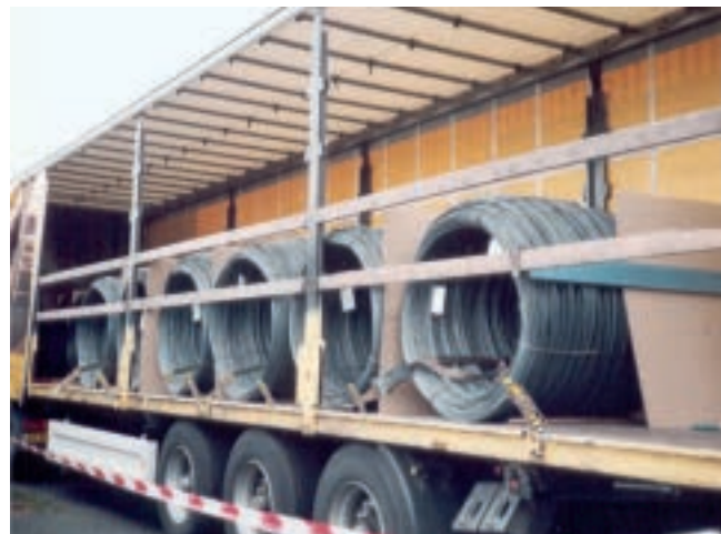
Abb. 10-87 Jede Rolle mit zwei Kopfschlingen sichern
