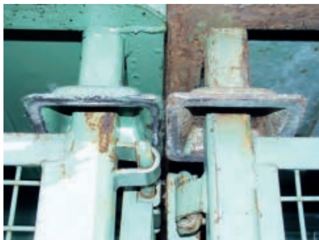
Abb. 10-58 Hier formschlüssig gestapelt: Gitterboxen
