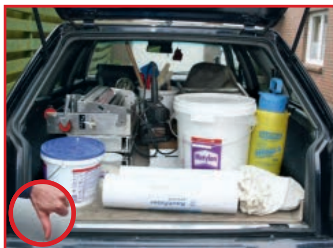
Abb. 10-7 Ungesicherte Ladung gefährdet Insassen
