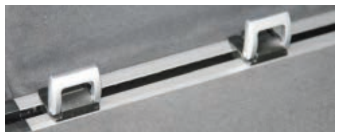
Abb. 6-48 Variable Zurrpunkte im Schienensystem
