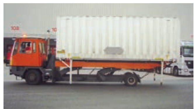
Abb. 1-13 Innerbetrieblicher Transport einer Beförderungseinheit für den kombinierten Verkehr
