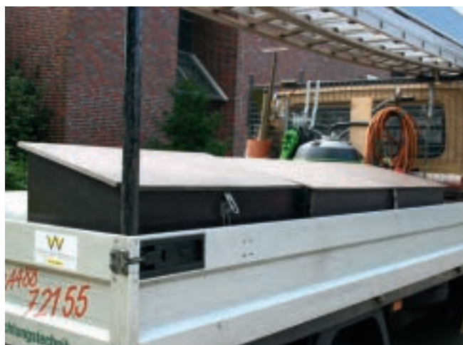
Abb. 10-16 / 10-17 Viele Möglichkeiten der Ladungssicherung in Transportern durch Netze und Transportbehälter
