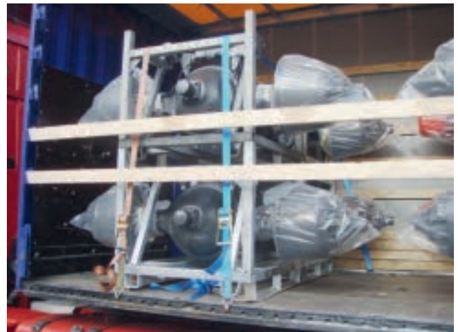
Abb. 10-55 Sicherung von Ladungsträgern durch Niederzurren
