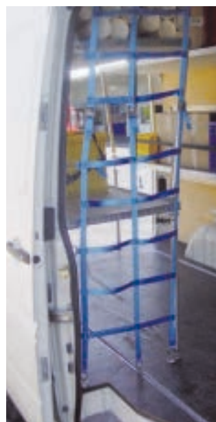
Abb. 6-50 Ein Gurtnetz bildet den gesamten Regalabschluss
