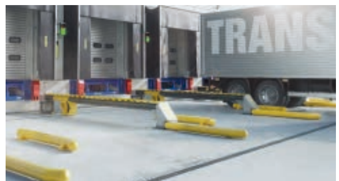
Abb. 2-16 Hat der Lkw die Beladestelle erreicht, schwenkt ein Blockierarm selbsttätig zwischen Rad und Schutzblech des Lkw und legt sich mit einer leichten Rückwärtsbewegung an diesen an.
