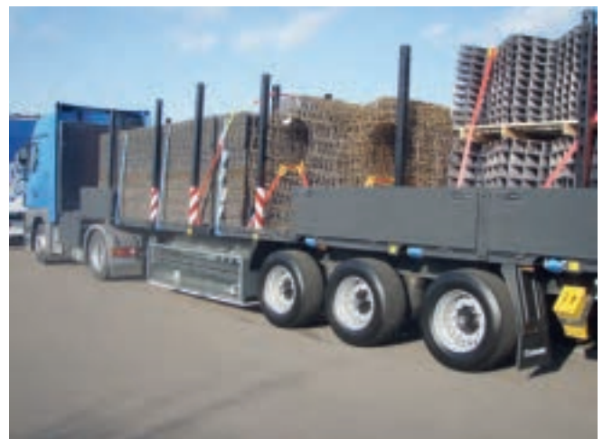
Abb. 10-76 Kombination aus Formschluss und Niederzurren
