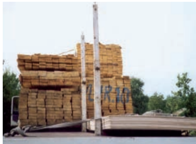
Abb. 10-31 Fixieren durch Mittelrungen
