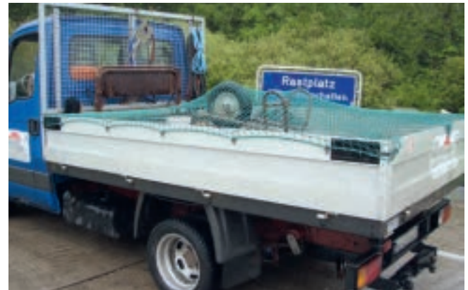
Abb. 10-13 Abdecknetz schützt andere Verkehrsteilnehmer
