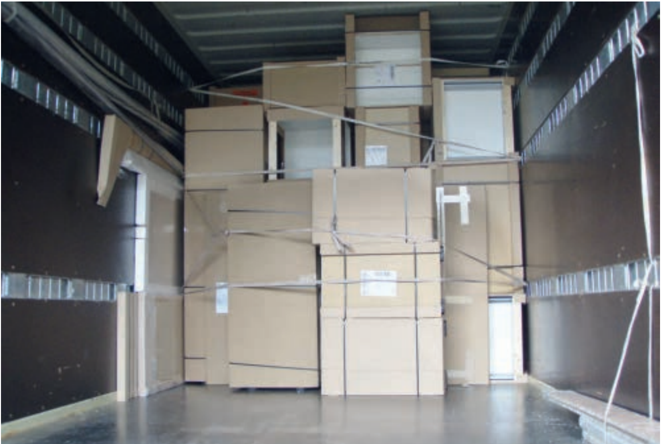
Abb. 10-46 Sicherung durch Direktzurren mit Gurtbändern
