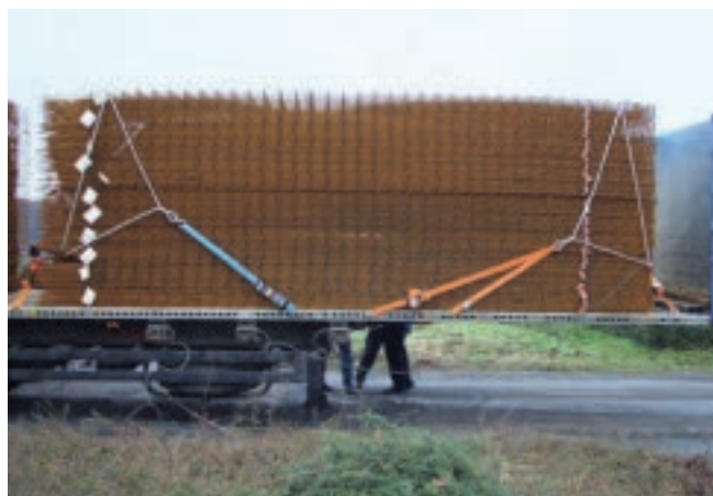
Abb. 10-79 Direktzurren durch Drahtseilssysteme
