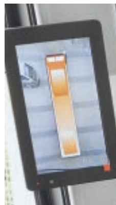
Abb. 2-9 / 2-10 360 Grad „birdview“-Videosystem, das den Fahrzeugführenden sogar einen Blick von oben auf das Fahrzeug er-möglicht.
