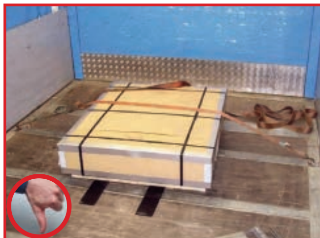
Abb. 10-102 Kein Formschluss und nur ein Zurrgurt: als Sicherung nicht ausreichend
