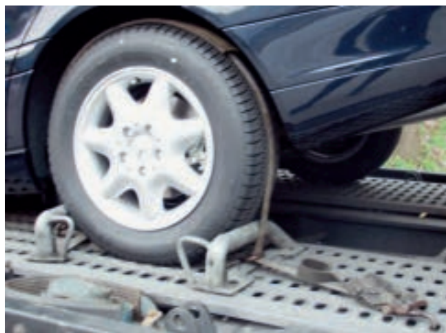
Abb. 10-109 Richtige Position für Drei-Punkt-Zurrgurt
