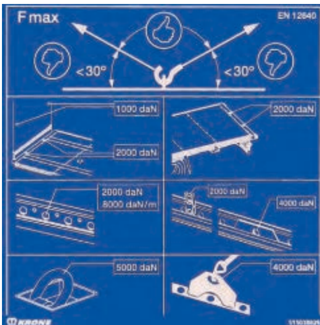
Abb. 5-27 Die DIN EN 12640 schreibt vor, dass alle Zurrpunkte, auch die Zurr-schienen, auf einer Lade-fläche, an gut sichtbarer Stelle mit einem Hinweisschild zu versehen sind, auf dem die zu-lässige Zugkraft der Zurr-schiene angegeben ist.
