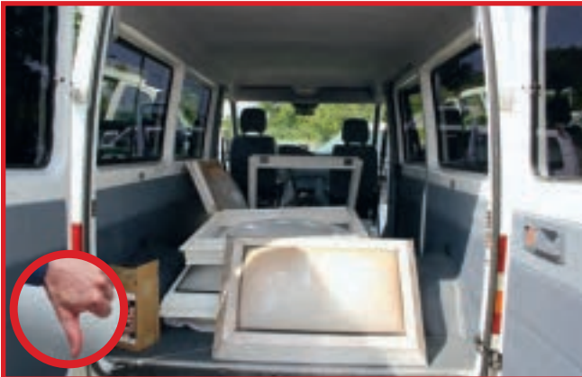
Abb. 10-9 "Einflugschneise" gefährdet die Insassen
