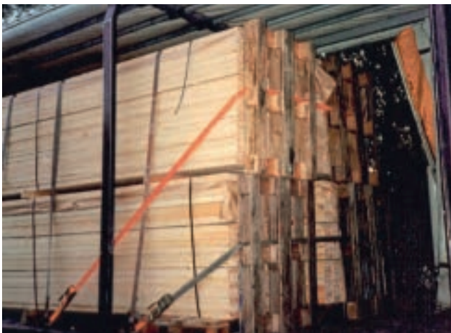
Abb. 10-29 Kopfschlinge mit Zurrgurten
