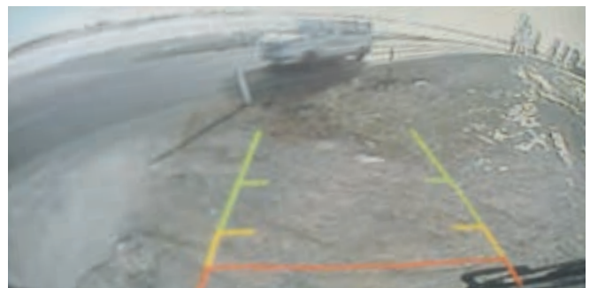
Abb. 2.8 Auf dem Bild der Rückfahrkamera ist das Geschehen hinter dem Fahrzeug erkennbar.
