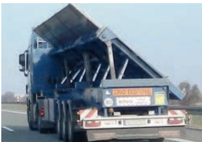
Abb. 10-70 Überbreite Bleche auf einem Schrägbock
