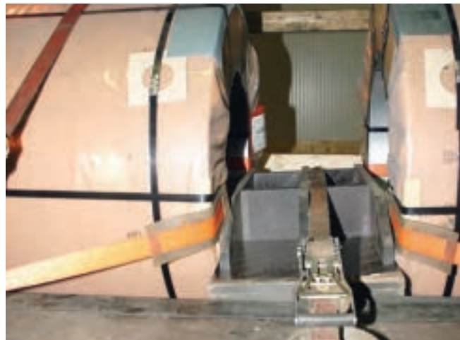
Abb. 10-66 Muldenabdeckbretter als Abstandhalter und Gurte mit Kantenschutz
