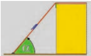
Abb. 7-18 \alpha etwa 50^\circ = die Vorspannkraft wirkt zu 75 %
