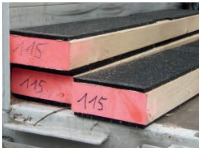
Abb. 10-37 Erleichtern die Arbeit: vorgefertigte Anti-Rutsch-Hölzer
