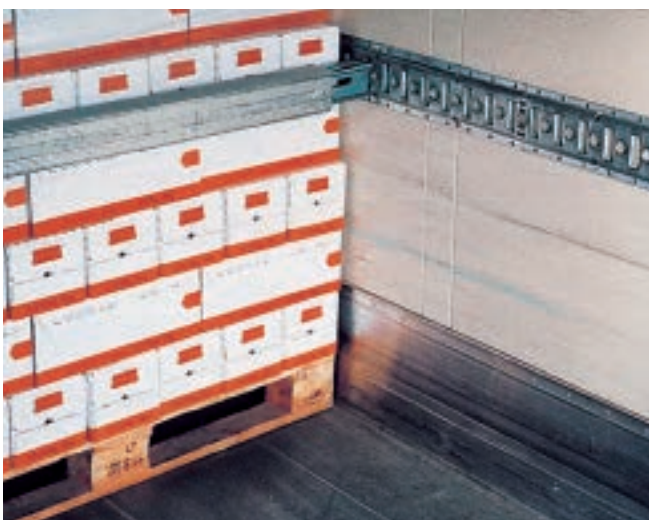
Abb. 6-60 Beispiel: Ankerschienen dienen der Aufnahme von Sperrbalken.
