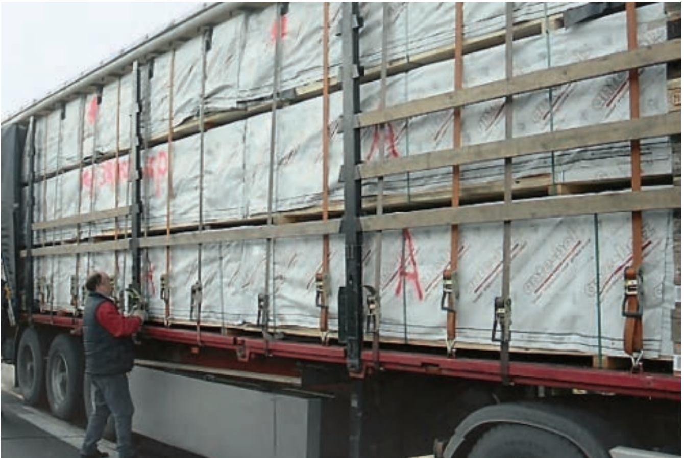
Abb. 10-39 Sicherung durch Niederzurren
