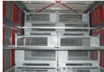
Abb. 7-11 Sicherungsprinzip: Der Fahrzeugaufbau und die Hilfsmittel zur Ladungssicherung (hier z. B. Sperrbalken) müssen die erforderlichen Sicherungskräfte aufnehmen können.
