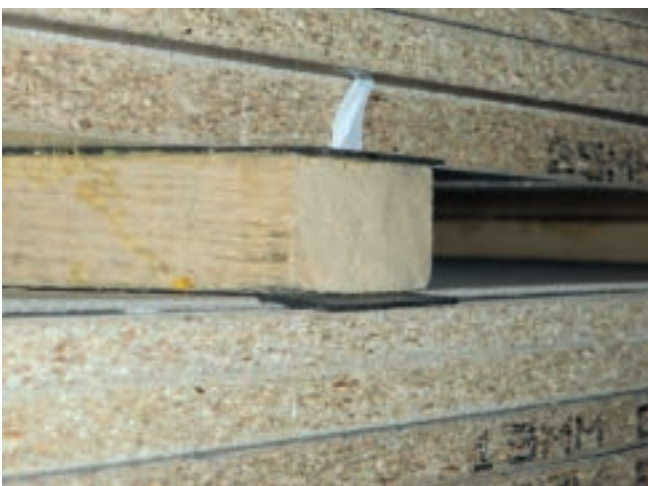
Abb. 10-33 Rutschhemmendes Material (Anti-Rutsch-Holz)
