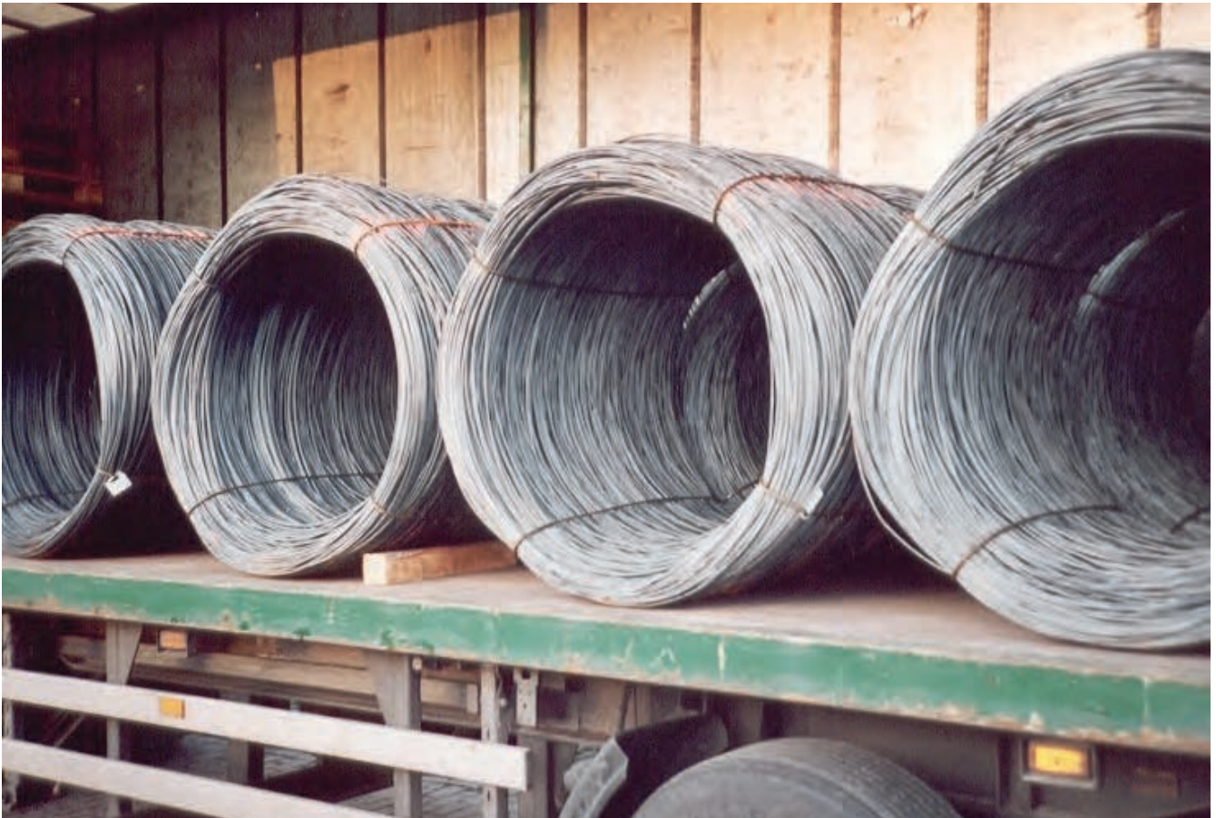
Abb. 10-81 Formschluss. Hinweis: Muss noch gegurtet werden!
