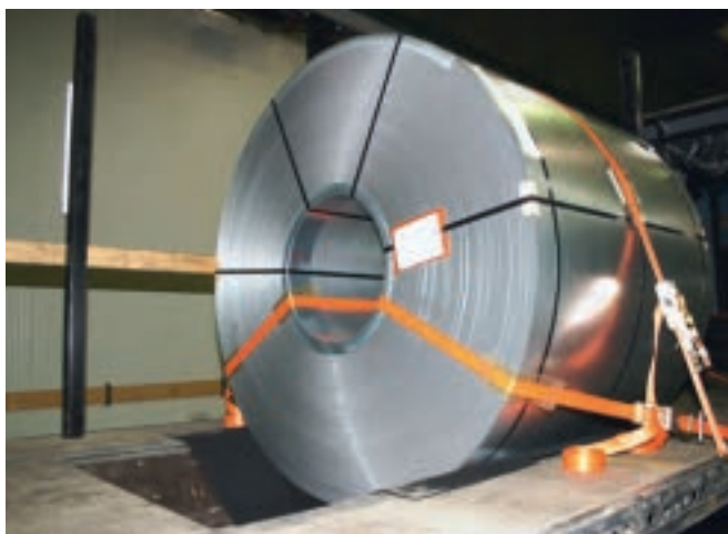
Abb. 10-64 Zurmittel zur rückwärtigen Sicherung nach vorn abspannen
