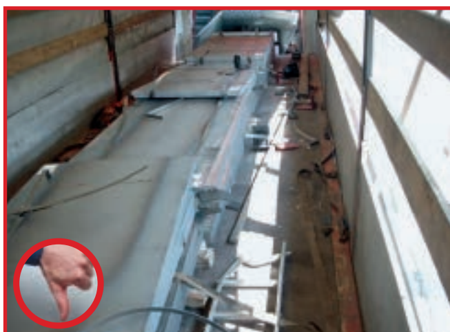
Abb. 10-100 Durch Vollbremsung zerstörte Ladeeinheiten
