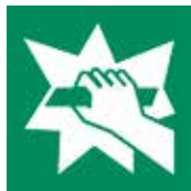
E08 Notausgangsvorrichtung, die nach Zerschlagen einer Scheibe zu erreichen ist
