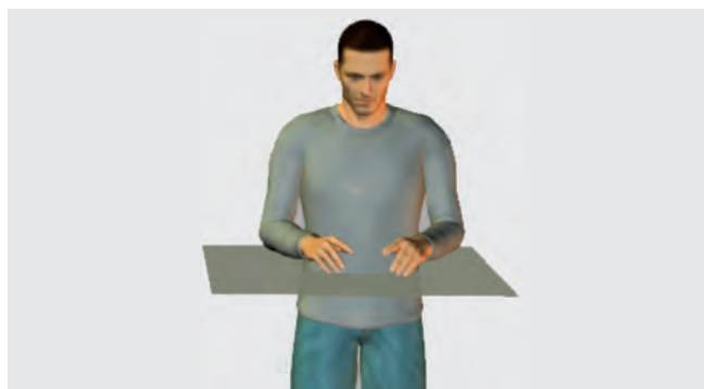
Bild 3-3: Da die Oberarme nie vollständig senkrecht hängen, liegen die Ellenbogen oberhalb der Mittelebene.
