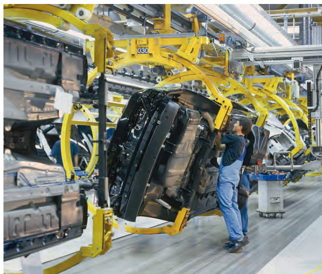
Bild 7-1: Durch die Schrägmontage in der Automobilfertigung wird die belastende Überkopparbeit ersetzt. Neben dem Belastungsabbau ergibt sich die Möglichkeit zur präziseren Arbeit und damit zur Erhöhung der Qualität. Diese Gestaltungsmaßnahme ist das Ergebnis einer komplexen Prüfung, Planung und Gestaltung
