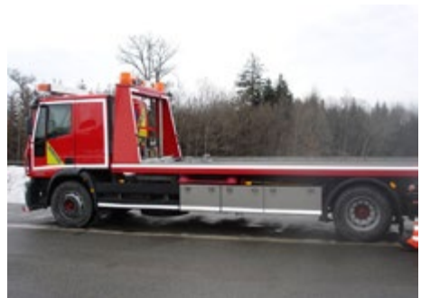
Abb. 3 Bergungsfahrzeug (LKW für Fahrzeugbeförderung (LFB), mit Kran (LFBK))
