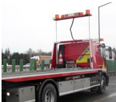
Abb. 7 Teleskopierbare, weit sichtbare Warnleuchten
