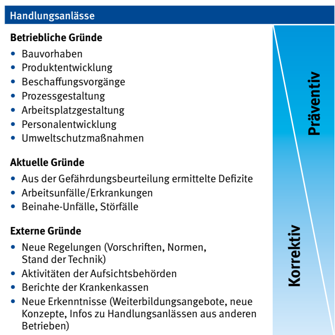
Abb. 6: Präventive und korrektive Handlungsanlässe im Arbeitsschutz
