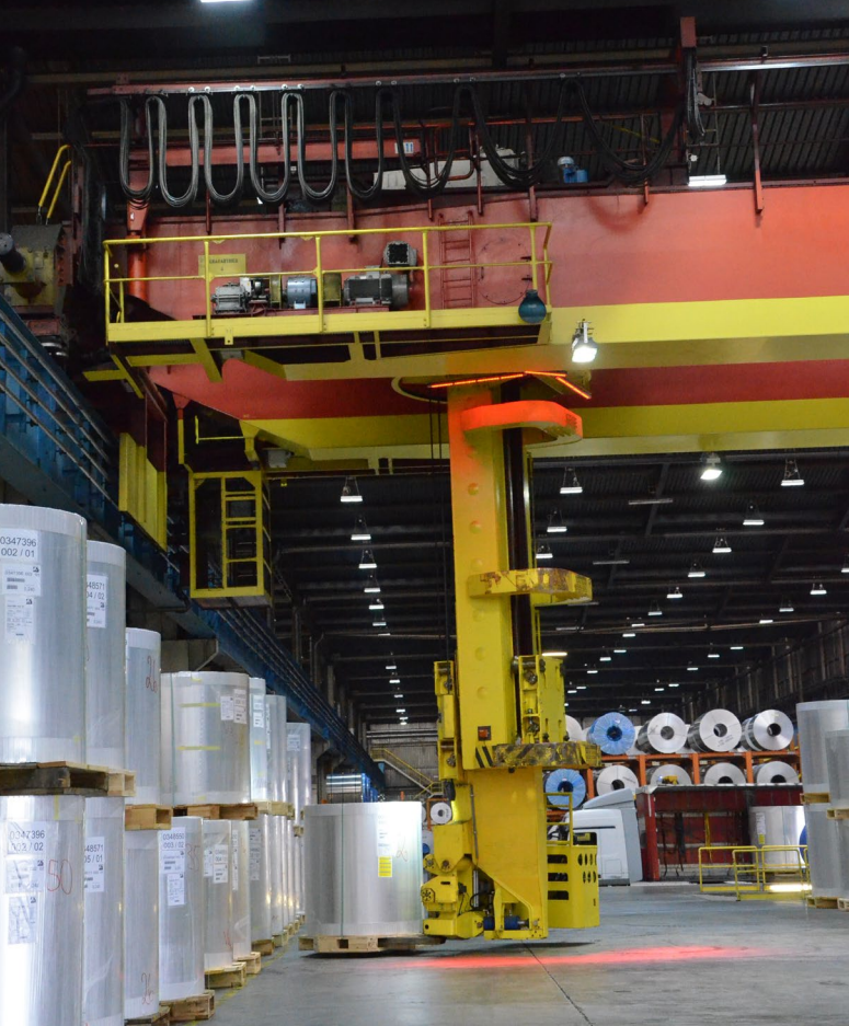
Abb. 10 Regalbedienkran mit starrer Lastführung, nicht teleskopierbar
