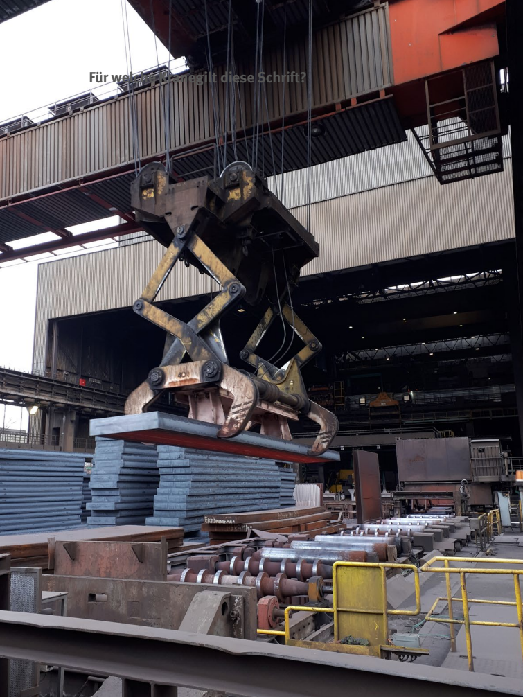
Abb. 5 Brammentransportkran mit Zange
