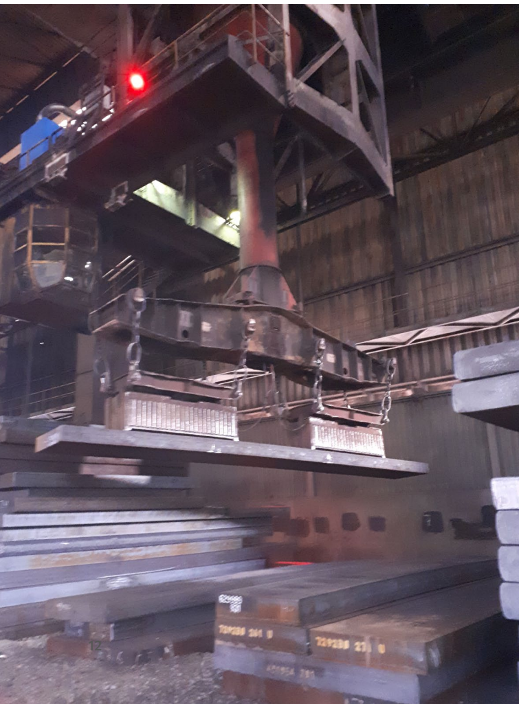
Abb. 6 Brammentransportkran mit Magnet
