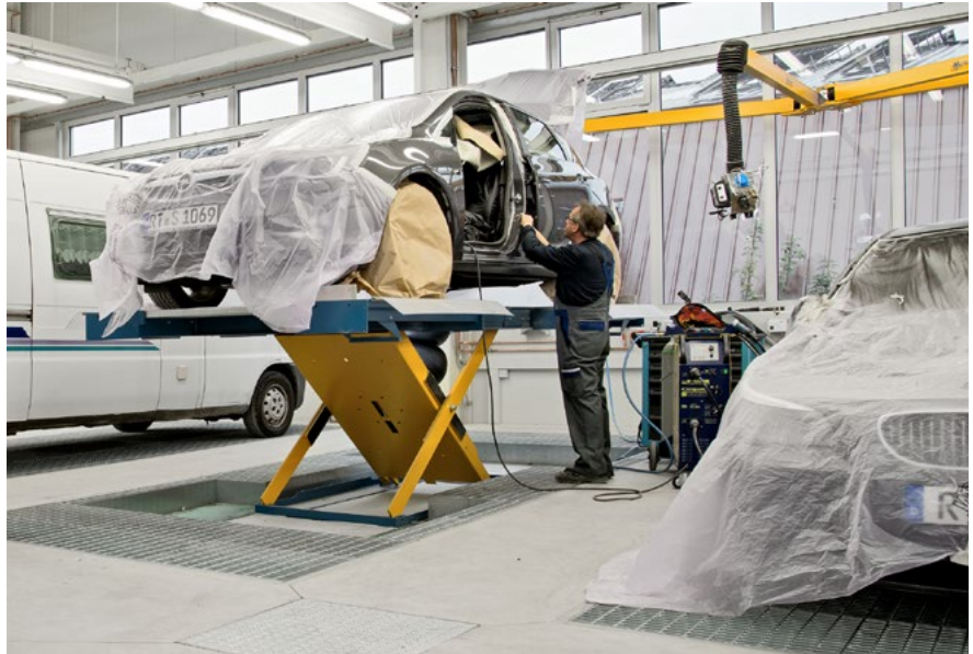
Abb. 15 Vorbereitungsplatz mit Fahrzeug-Hebebühne
