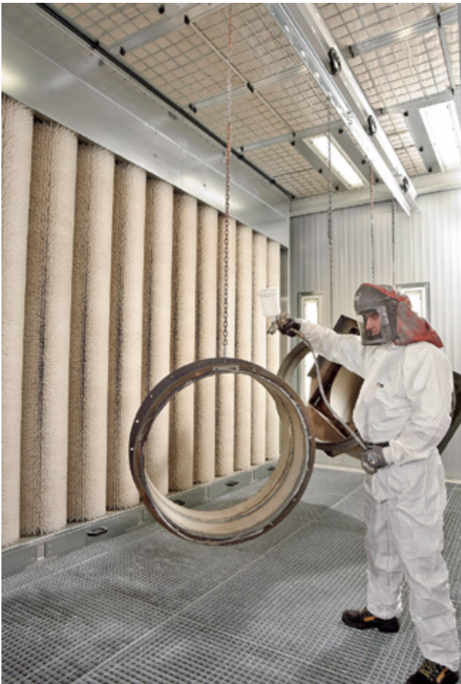
Abb. 8: Trockenabscheidung mit Rotationsbürsten
