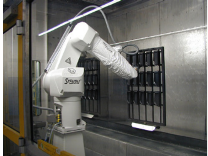
Abb. 9: Nassabscheidung mit Roboterapplikation
