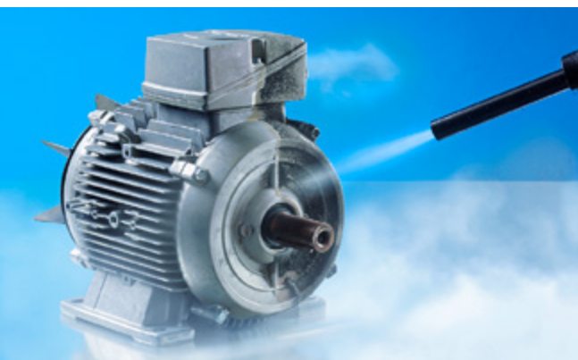
Abb. 11: Werkstückreinigung mit CO 2
