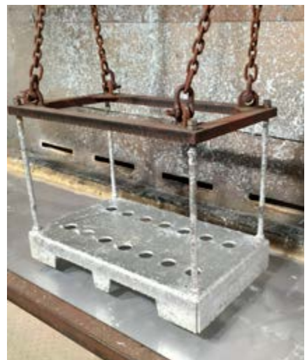
Abb. A1.6 Beispiel für ein Zinkeinlassgestell
