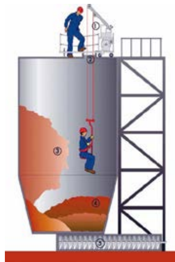
Abb. 7.14 Prinzip-Skizze zum Befahren eines Silos
