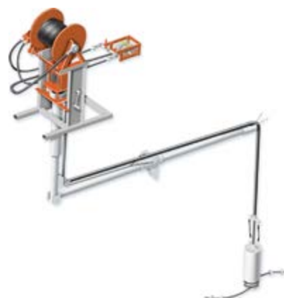
Abb. 8.4 Gelenkarm mit pneumatisch betriebenen Rotationsmotor
