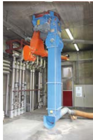
Abb. 7.10 Späneentnahme über Anschluss an gesonderten Entnahmestutzen
