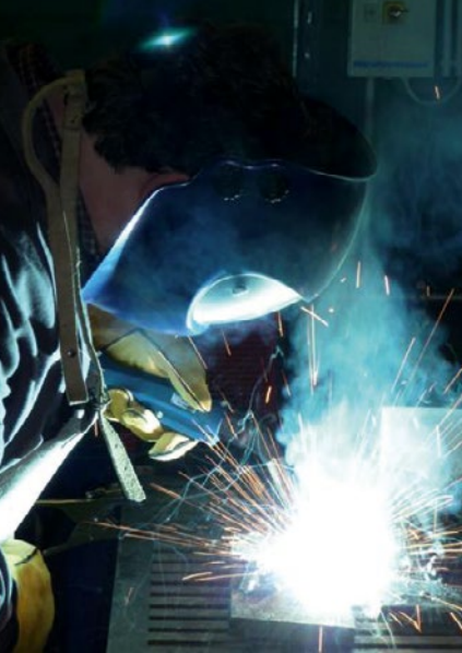
Abb. 1 Aufsteigender Schweißrauch ohne Absaugung
