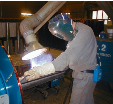
Abb. 4 Absaugarm mit Erfassungselement
