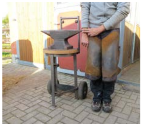
Abb. 2-3 Ambosshöhe zum Richten
