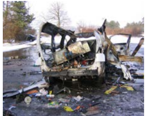
Abb. 9-1 Fahrzeug nach Druckgasflaschenexplosion
