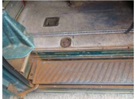
Abb. 9-2 Belüftungsöffnung im Fahrzeugboden
