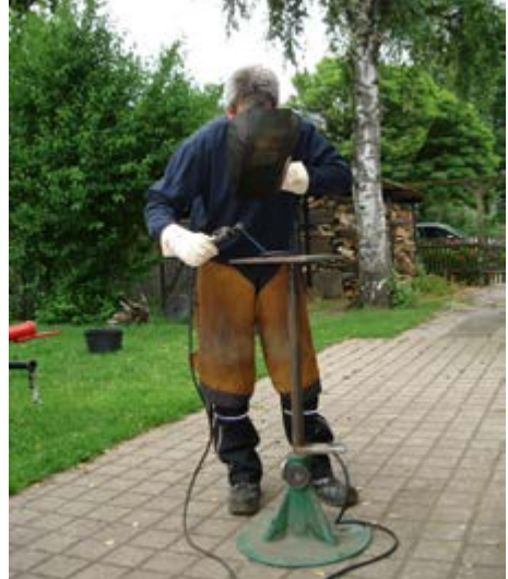
Abb. 5-7 Persönliche Schutzausrüstung beim Schweißen
