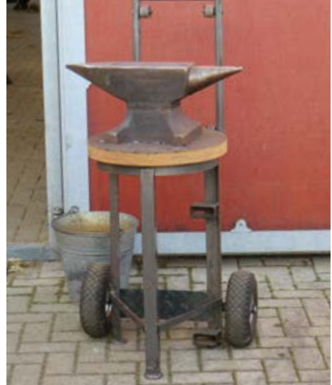
Abb. 3-1 Amboss auf lärmindernder Holzplatte
