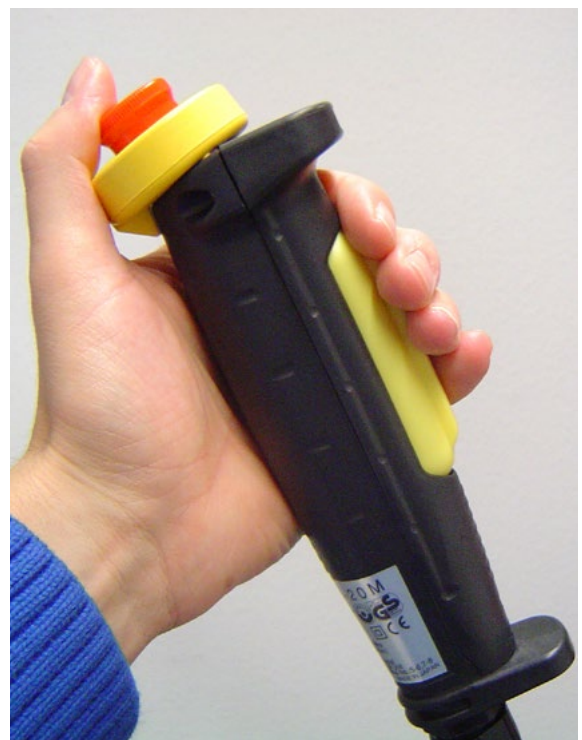
Abb. 55 Zustimmungsschalter bei der Störungssuche [H]
