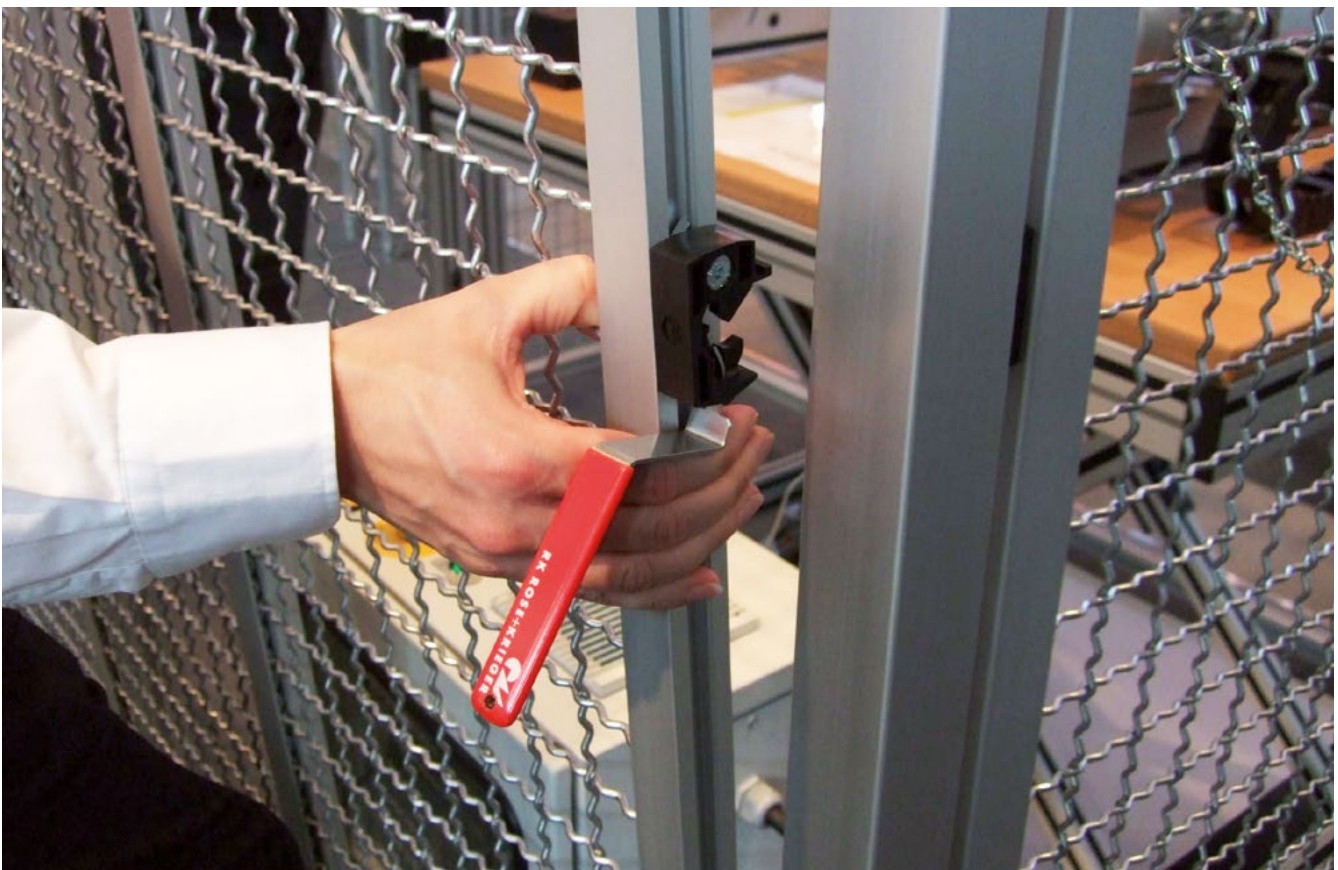
Abb. 37 Befestigungsmittel bleiben nach dem Abnehmen der Schutzeinrichtungen mit den Schutzeinrichtungen oder mit der Maschine verbunden (Beispiel). [H]
