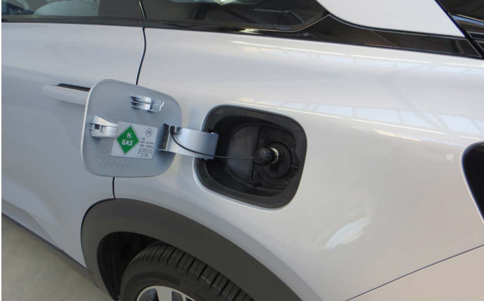
Abb. 8 Beim Tanken und in der Werkstatt sollen die Fahrzeuge an einen Potenzialausgleich angeschlossen werden.
