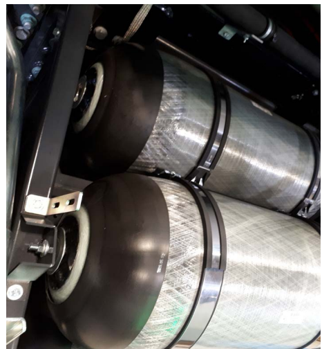
Abb. 3 Ein Tanksystem kann wie hier aus mehreren gekoppelten Speichern am Fahrzeug verbaut werden.
