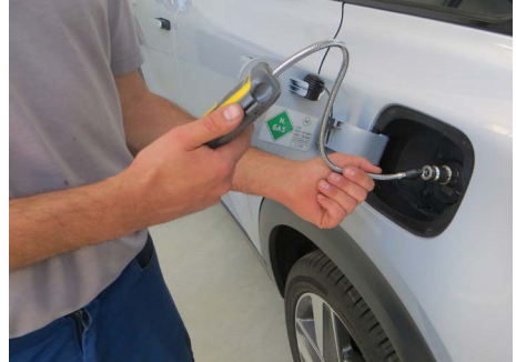
Abb. 12 Nach Arbeiten an Tanksystemen werden Lecktester eingesetzt.
