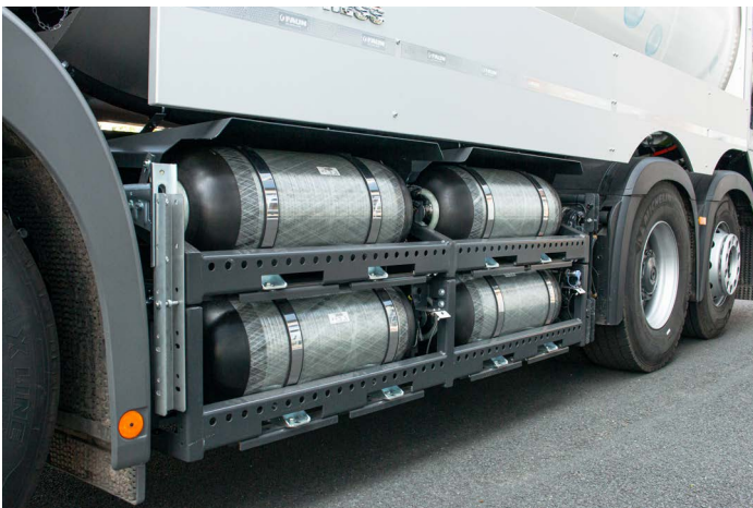
Abb. 6 Die CGH 2 -Druckbehälter sind hier am Fahrgestell eines Nutzfahrzeugs angebracht. Für Arbeiten an Tanksystemen auf dem Dach, z. B. bei Bussen, sind besondere Maßnahmen zur Absturzsicherung zu treffen.
