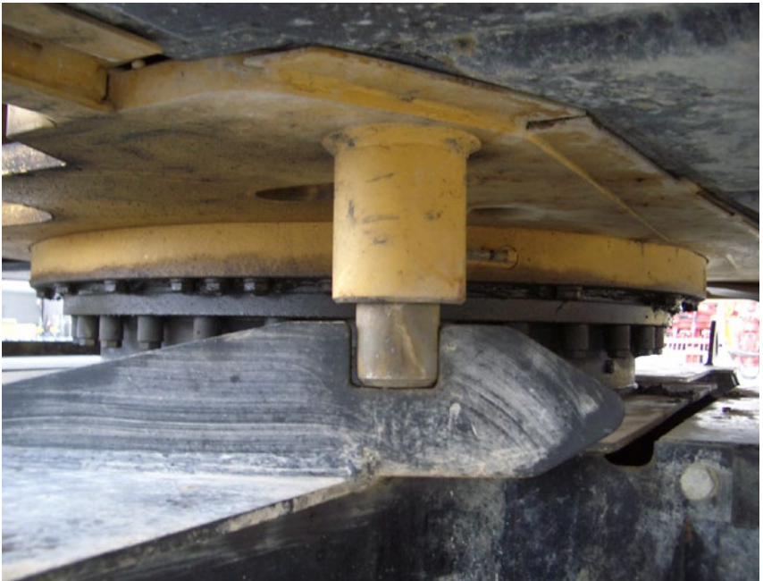
Abb. 40 Dreh Sperre an einem Hydraulikbagger in Sperrstellung
