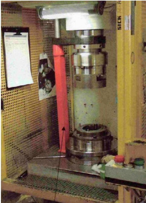
Abb. 28 Eingesetzte Abstützung an einer hydraulischen Presse
