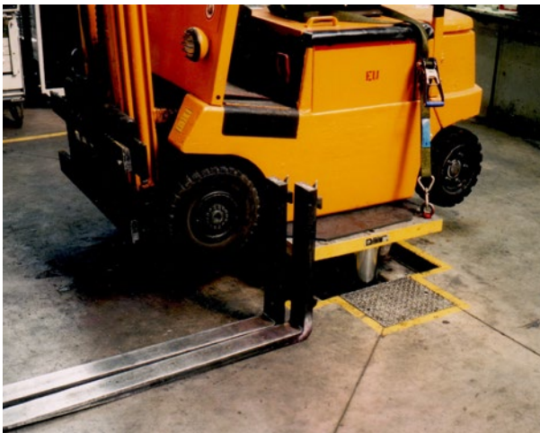
Abb. 35 Demontierte Hubgabeln bei Arbeiten an der Staplerhydraulik
