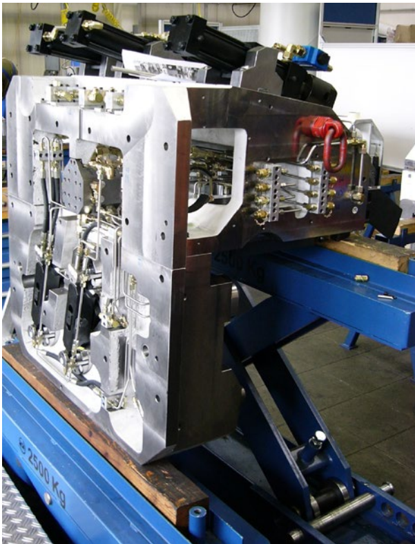
Abb. 27 Komplexes Spann- modul einer Transferstraße
