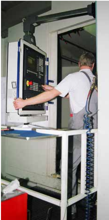
Abbildung 31: Ungünstige Anordnung des Bedienpultes
