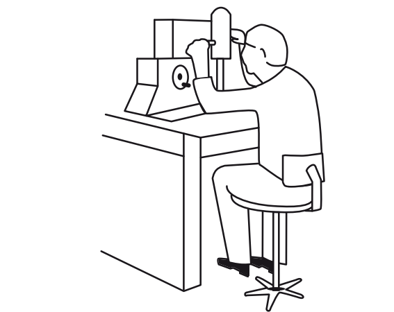
Abbildung 10: Angehobene Arme durch zu hohe Stellteile
