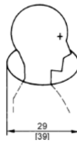
Abbildung 5: Zugangsöffnung für den Kopf bis zur Schulter für Prüftätigkeiten (Quelle: Bild 4.2 der DIN EN 547-2:2009-01)
