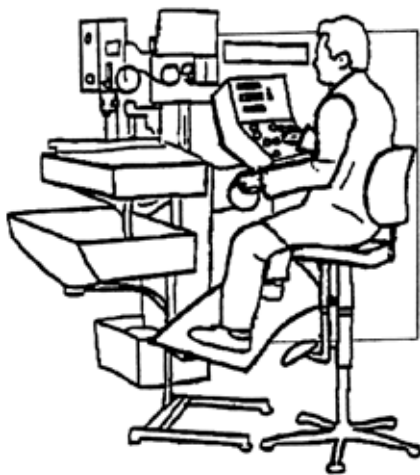
Abbildung 40: Beispiel für einen Arbeitsplatz mit erhöhter Sitzposition (Quelle: Bild 3 der DIN EN ISO 14 738:2009-07)
