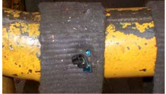
Bild 4-4: Durch heißen Span beschädigte Oberfläche
