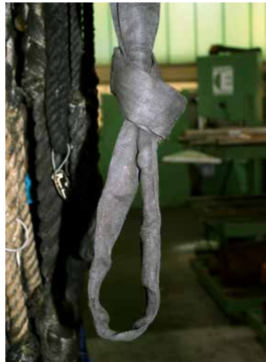
Bild 1-3: Unzulässiger Knoten in einer Rundschlinge
