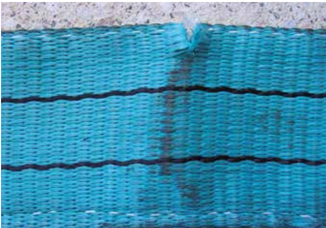
Bild 4-2: Unzulässiger Einschnitt an der Hebekante
