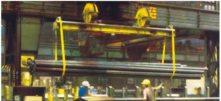
Bild 1-11: Sicheres Anschlagen langer Lasten
