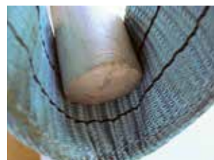
Bild 1-8: Unzulässige Auflage der Last im Hebeband
