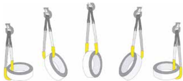
Bild 1-7: Wenden von Coils
