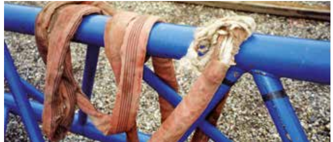
Bild 4-5: Starke Beschädigung der Ummantelung und der Einlage
