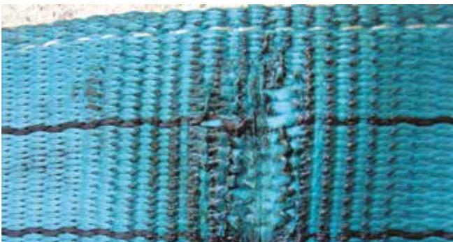
Bild 4-3: Durch Wärmeeinfluss beschädigte Oberfläche
