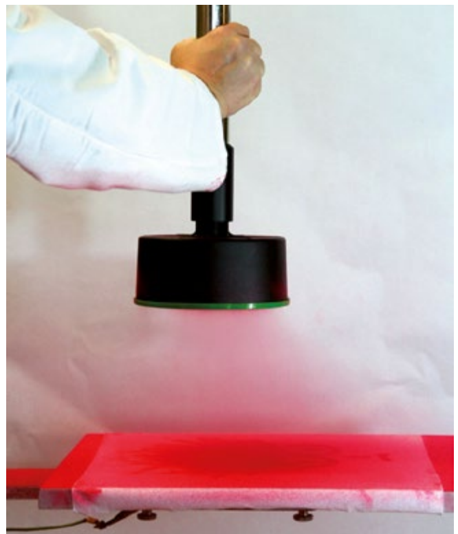
Abb. A10-12 Manuelles Beflocken von Textilien mit Handsprüheinrichtung
