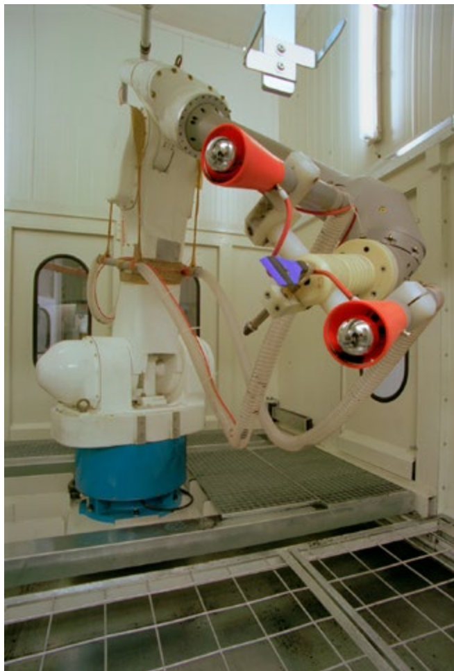
Abb. A10-15 Robotergeführte Beflockungsanlage mit luftzerstäubenden Sprühsystemen
