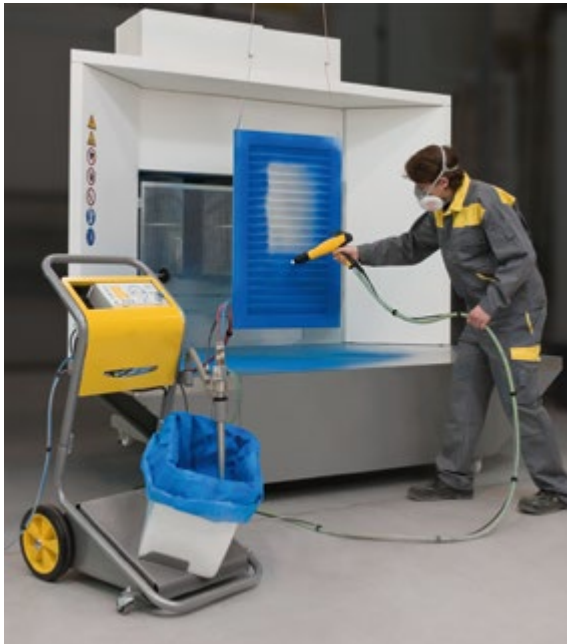
Abb. A10-7 Handsprüheinrichtung mit Sprühkabine
