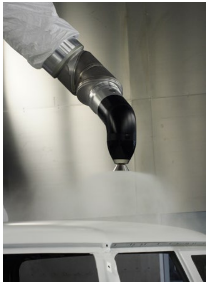
Abb. A10-6 Hochrotations-Sprühsystem zur Beschichtung von Pkw-Karosserien mit Direktaufladung
