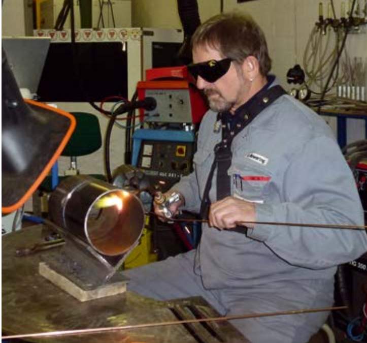
Abb. 4-3 Gasschweißen mit Absaugung
