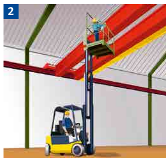
Instandhaltungsarbeiten mit Gabelstapler und Arbeitsbühne
