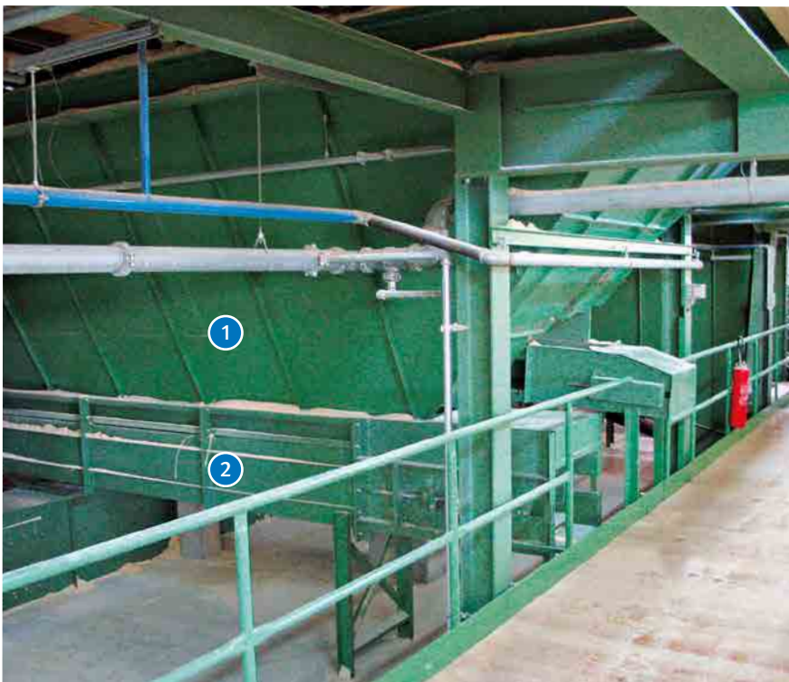
Abb. 22 Ausführungsbeispiel Entsorgung Nachschnittsäge
