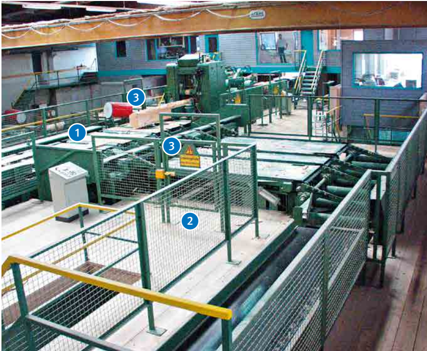
Abb. 33 Ausführungsbeispiel Winkelübergabe nach Hochleistungsgatte
