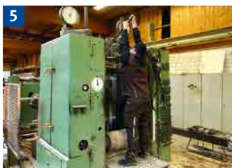
Spannen der Sägeblätter von geeigneter Standfläche aus
