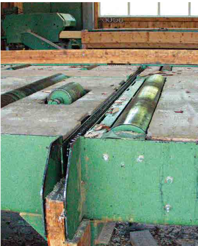
Abb. 32 Querförderer als Winkelübergabe im Abzugsrollengang (untere Endstellung)
