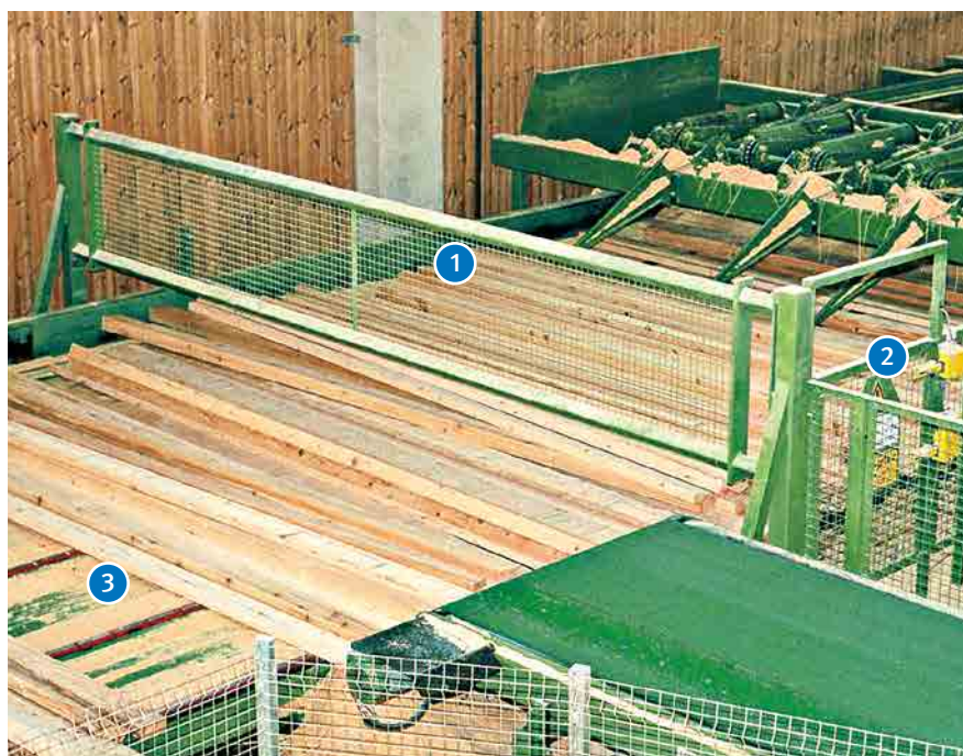
Abb. 28 Ausführungsbeispiel Stetigförderer für Seitenwarenabtransport, um den Zugang zum Gefahrenbereich der Einschnittlinie zu verhindern
