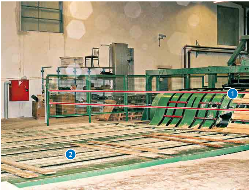
Abb. 29 Ausführungsbeispiel Stetigförderer für Seitenware zwischen Einschnittlinie und Besäumanlage
