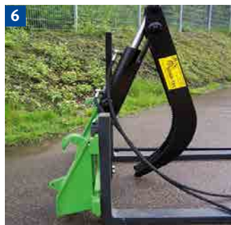
Gabelstapler mit Zangengreifer zum Transport von Rundholz
