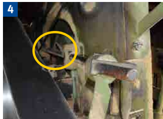
Formschlüssige Sicherung gegen Herabsinken des Sägerahmens
