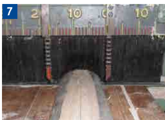
Eine leichtgängige Rückschlagsicherung umschließt das Werkstück lückenlos und verhindert das Heraus-schleudern von Splintern.
