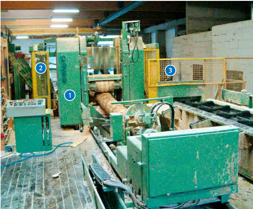
Abb. 4 Vertikalgatter mit handgesteuertem Spannwagen und gleisgeführter Steuerkabine
