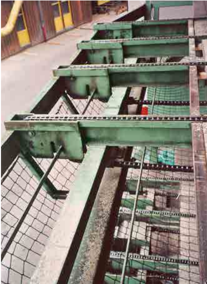
Abb. 43 Netz als Absturzsicherung an erhöhten Stapelbereichen
