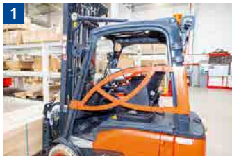
1 Fahrerückhalteinrichtung (hier: Bügeltür) bei jeder Fahrt benutzen.
