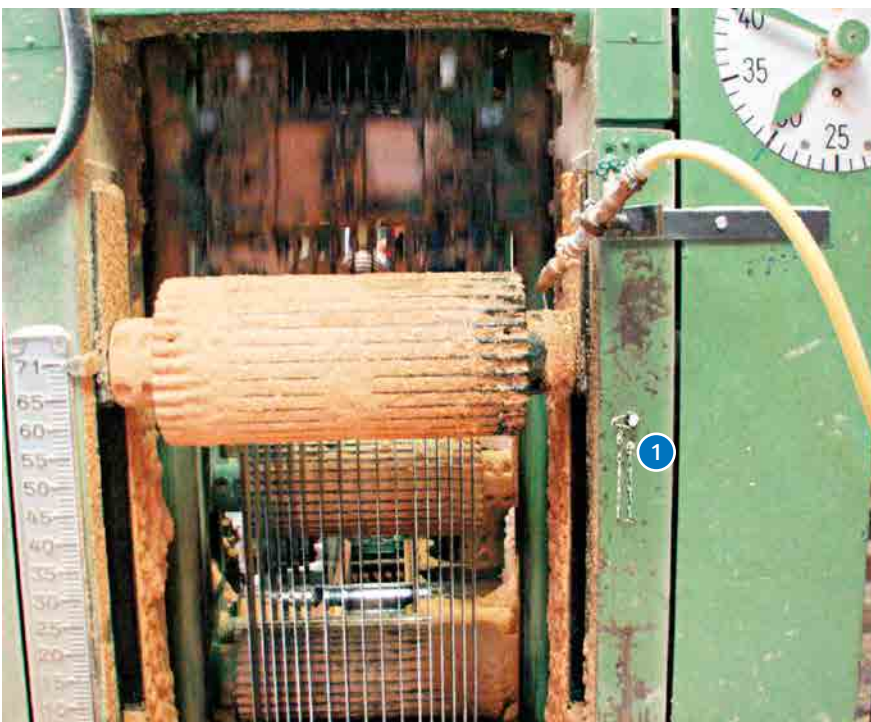
Abb. 5 Druckwalzensicherung durch einen Sicherungsbolzen
