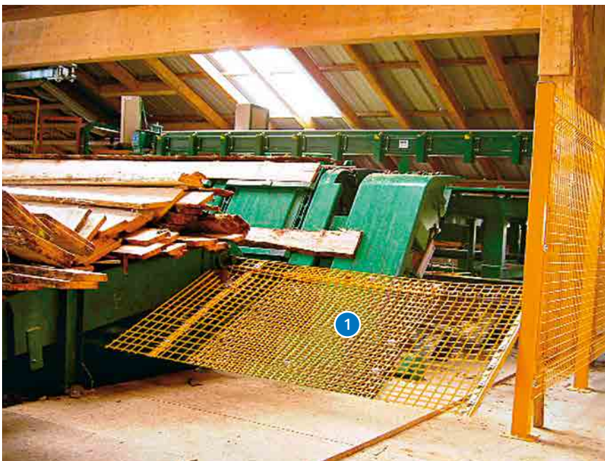
Abb. 30 Ausführungsbeispiel einer abwesenden Schutzvorrichtung als Teil der Zugangssicherung zum Gefahrenbereich einer Vereinzelung
