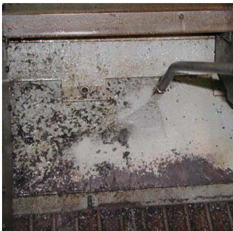
Bild 35 Reinigung mit Niederdruckgerät
