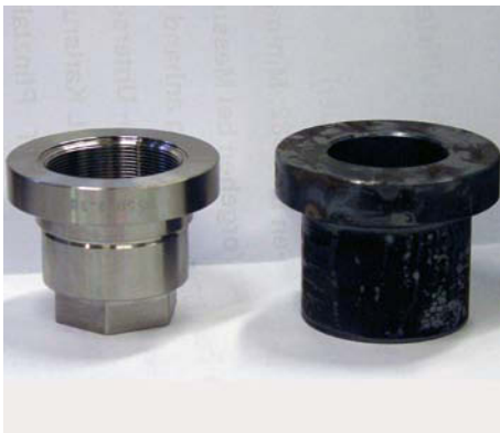
Bild 42 Bearbeitete Revolvermutter und Rohling; Material: CK 45
