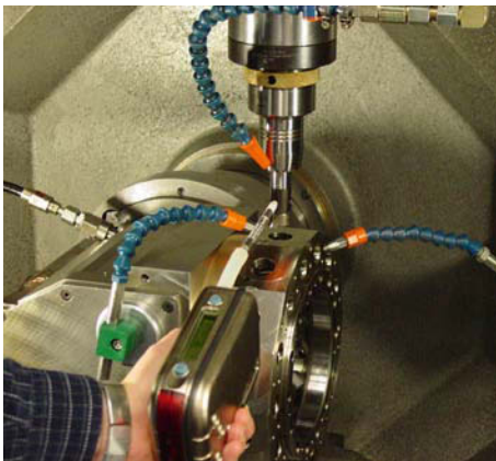
Bild 40 Bestimmung der Kohlenmonoxidkonzentration mit einem direkt-anzeigenden Messgerät
