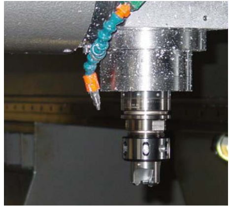
Bild 53 Äußere Schmierstoff-Zufuhr beim Fräsen
