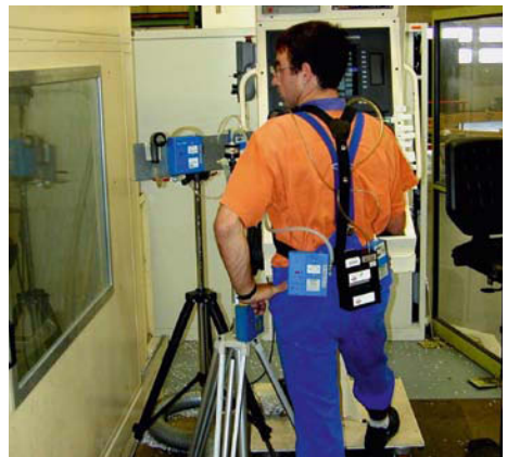
Bild 41 Expositionsmessungen stationär sowie personengetragen am Bedienpult
