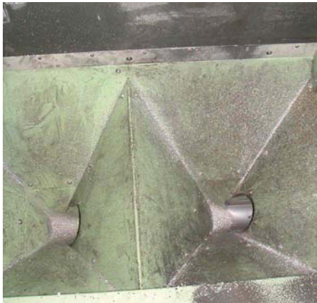
Bild 31 Absaugung über Späneförderer
