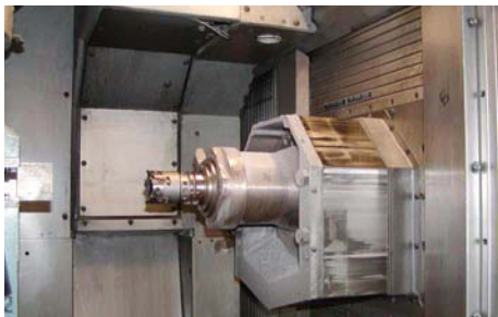
Bild 23 Nutzung der Schwerkraft zur Späneabfuhr, steile Bleche
