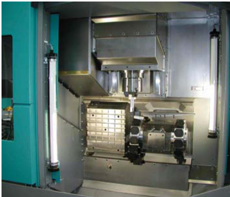
Bild 21 Innenansicht einer MMS-Werkzeugmaschine
