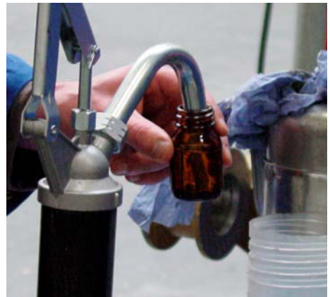
Bild 3 Schmierstoffbedarf einer Arbeitsschicht bei Minimalmengenschmierung
