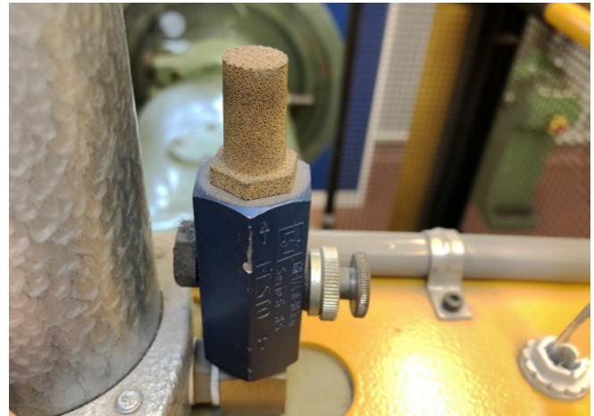
Abb. 26 Sintermetall-Schalldämpfer an pneumatischer Steuerung
