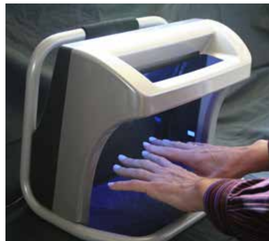
Abb. 4-15 Testgerät (UV-Lampe) zur Überprüfung des Hautschutzes
