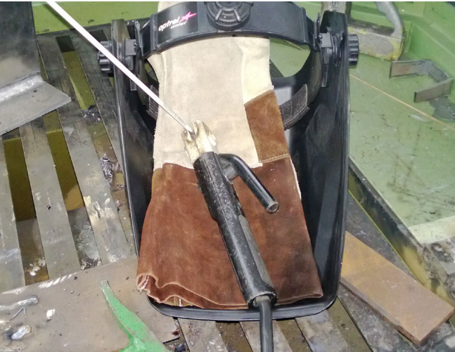
Abb. 6-4 Stabelektrodenhalter immer isoliert ablegen
