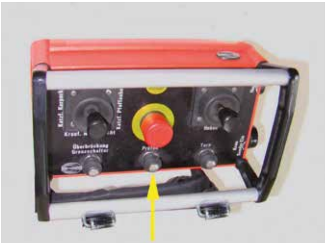
Bild 4-10: Zum Prüfen des Hubnotendschalters muss der Betriebsendschalter – falls vorhanden – überbrückt werden können. Der entsprechende Schalter ist in der Steuertafel untergebracht
