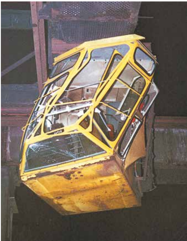
Bild 4-7: Bei der Kranfahrt stieß die Unterkante des Führerhauses an zu hoch gelagertes Material
