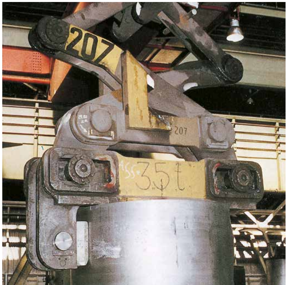
Bild 5-5: Coil wird in der Coillzange nur durch Reibkräfte gehalten
