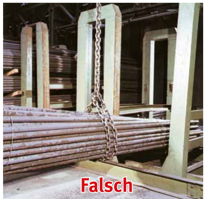
Bild 5-18: Derart lange Lasten dürfen nicht an nur einer Kette – selbst im Schnürgang – angehängt werden
