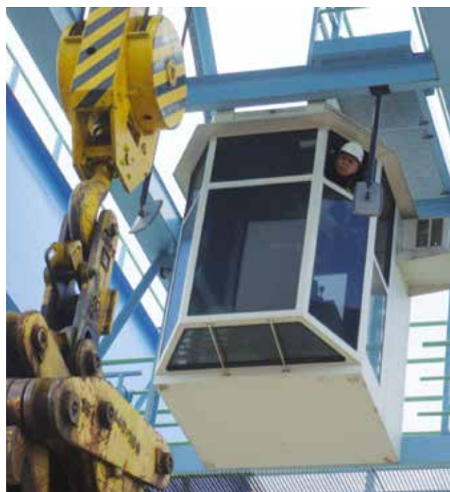
Bild 3-8: Der Kranführer zeigt sein Einverständnis für das Betreten des Kranes
