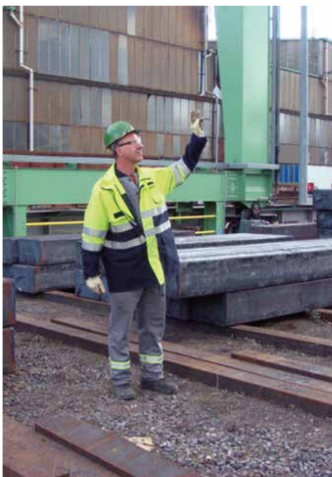
Bild 3-7: Die Person, die den Kran betreten will (z. B. Ablöser, Kranschlosser, Kranelektriker), gibt dem Kranführer Zeichen, den Kran anzuhalten, damit sie aufsteigen kann
