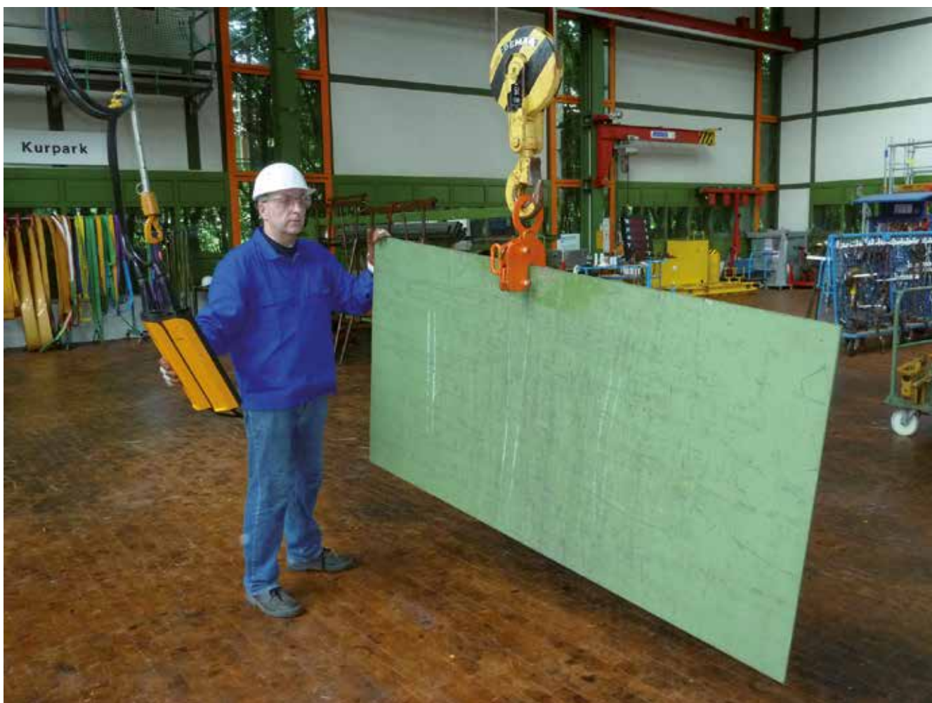
Bild 5-7: Der Kranführer ist stark gefährdet, wenn er sich in unmittelbarer Nähe von Lasten aufhält, die nur kraftschlüssig – in diesem Fall mit einer Blechklemme – gehalten werden
