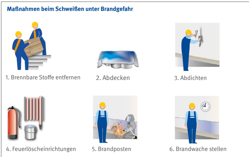
Abb. 8-3 Maßnahmen beim Schweißen unter Brandgefahr
