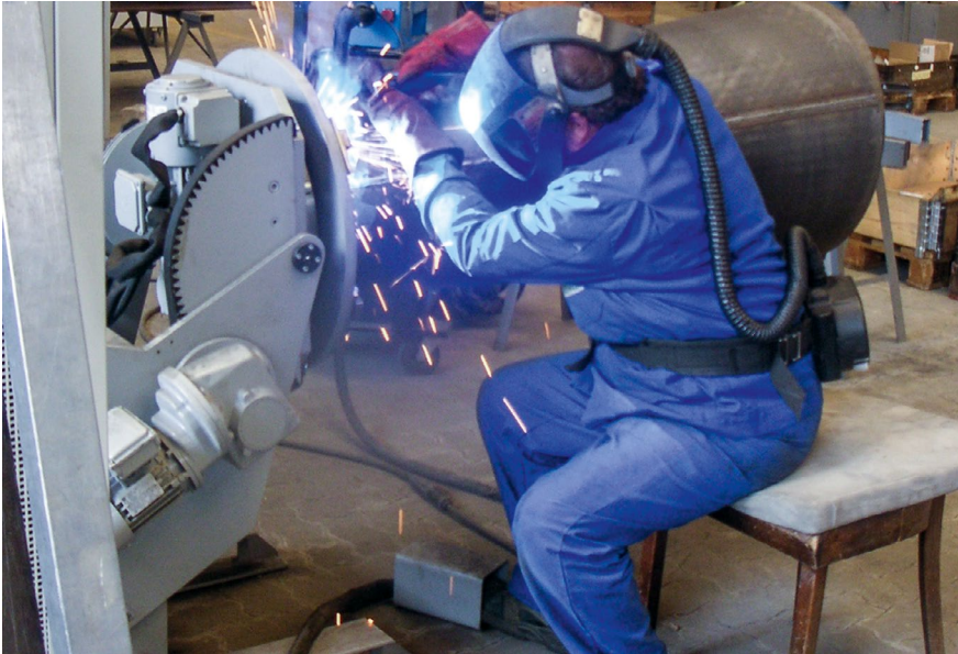
Abb. 4-5 Mit oder ohne Auflage – trockenes Holz isoliert beim Lichtbogenschweißen
