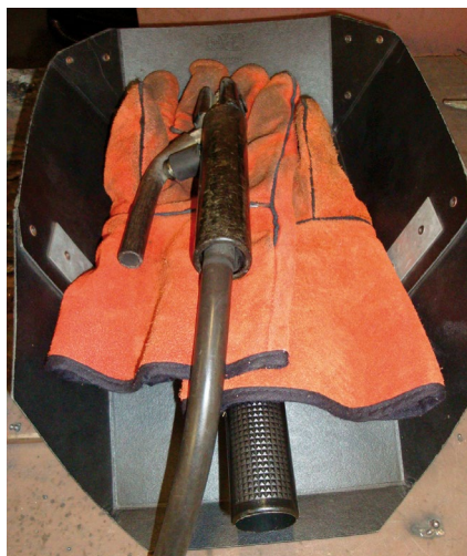
Abb. 4-2 Ohne Elektrodenrest isoliert abgelegter Stabelektrodenhalter
