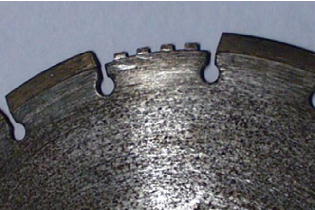
Abb. 22 Diamanttrennschleifscheibe mit abgerissemem Segment
