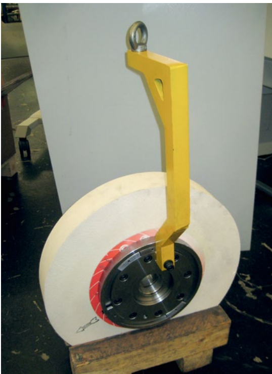
Abb. 13 Schleifscheibentransport mit Lastaufnahmemittel
