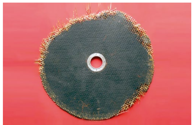
Abb. 21 Trennschleifscheibe nach Rückschlag
