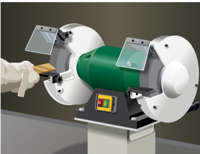
Abb. 8 Ständerschleifmaschine mit nachstellbarer Werkstückauflage und Stirmschieber
