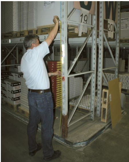
Abb. 6 Überprüfung der Fachhöhe
